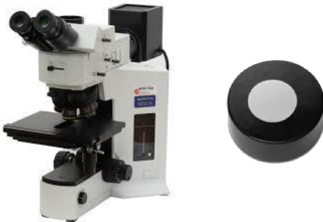
Slika 5.4 Olympus BX51 M svjetlosni optički mikroskop i uzorak spreman za metalografsku analizu
