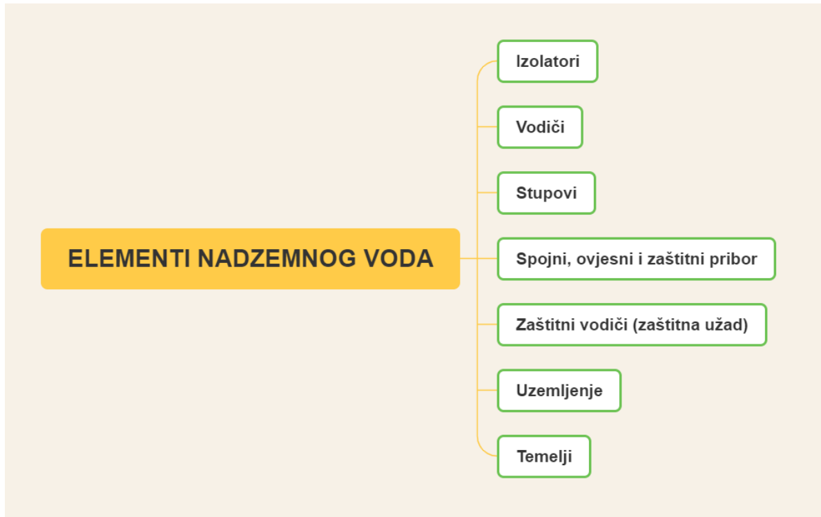
Slika 2.3 Glavni elementi nadzemnog vod
