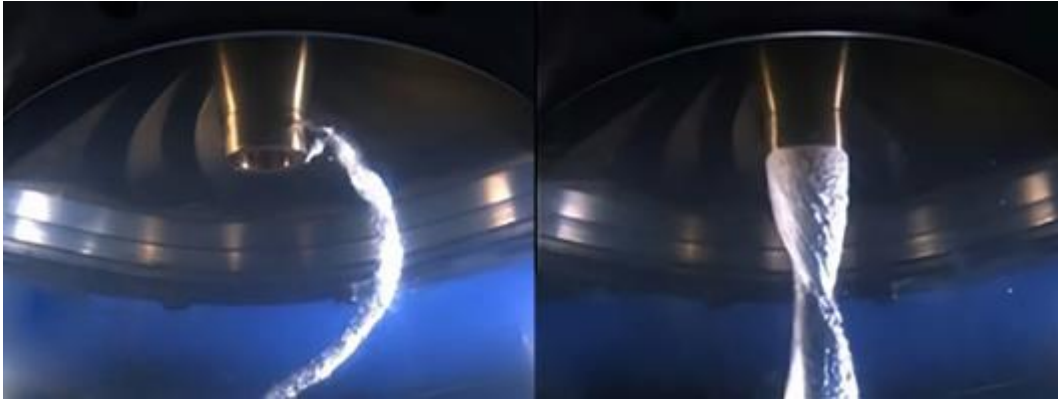
Slika 6.2 Prikaz strukture vrtložnog užeta kod Francis turbine [20]
