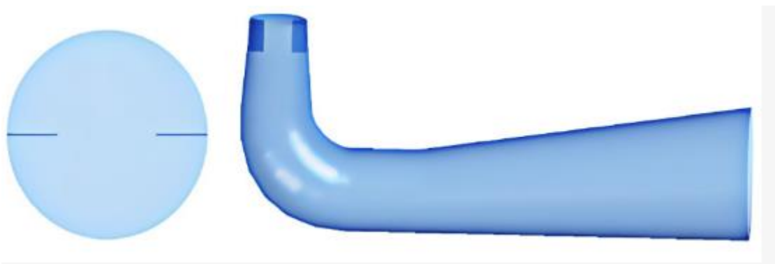
Slika 6.3 Shematski prikaz postavljene pregrade na ulazu u difuzor [20]
