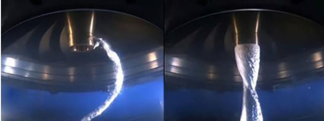
Slika 6.2 Prikaz strukture vrtložnog užeta kod Francis turbine [20]
