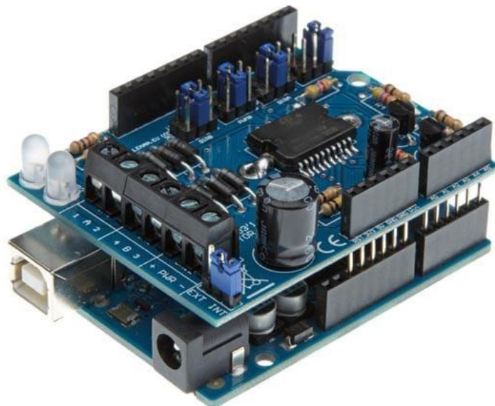
Slika 3.2. Arduino Shield povezan na Arduino
