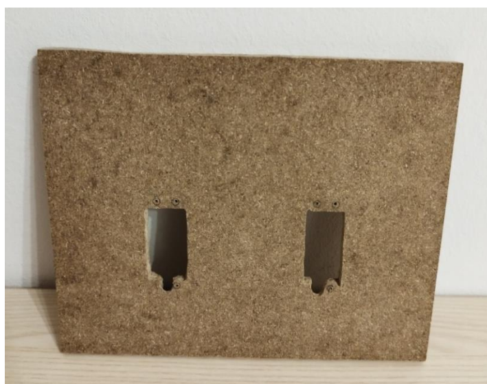
Slika 6.1. Iverica2 s utorima za motore
