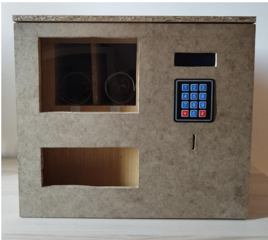
Slika 6.4. Prototip samoposlužnog automata temeljen na Arduinu
