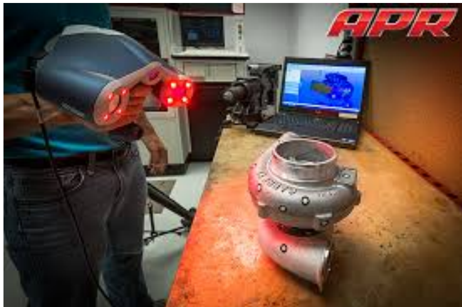
Slika 7.3. 3D skeniranje turbopuhala.
