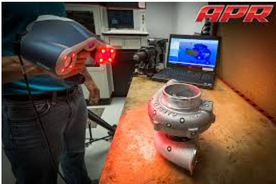
Slika 7.3. 3D skeniranje turbopuhala.
