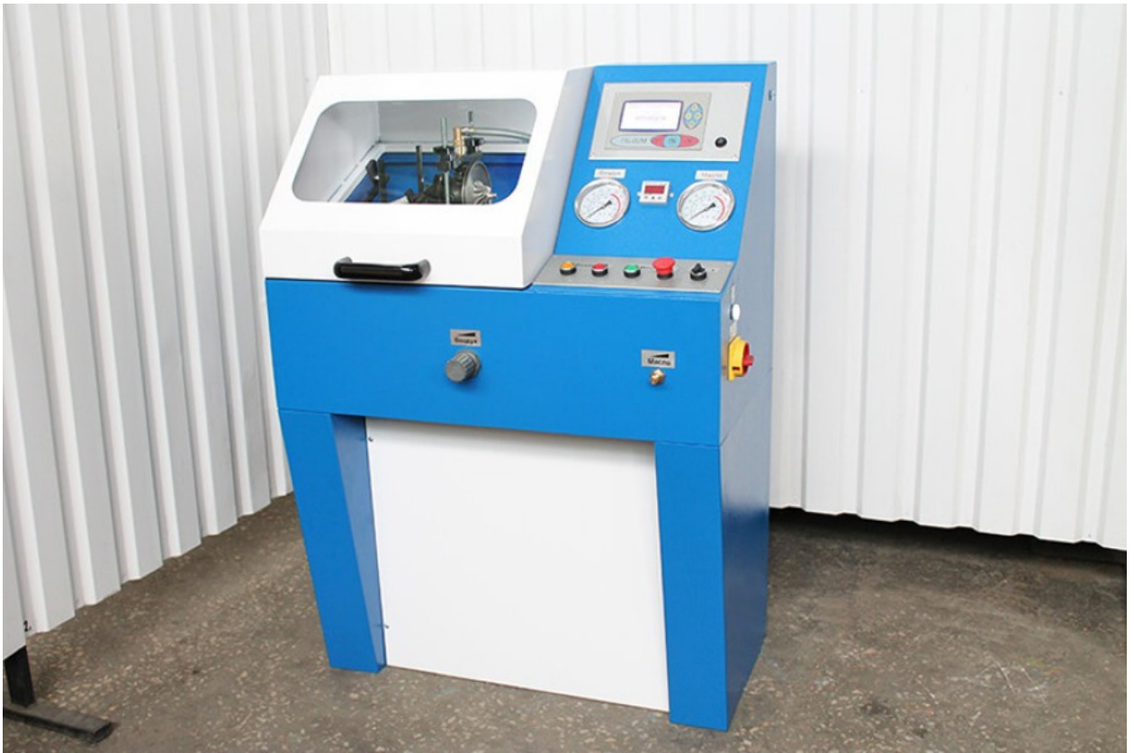
Slika 6.8. Uređaj za testiranje okretanja dijelova koji radi po principu niskih brzina
