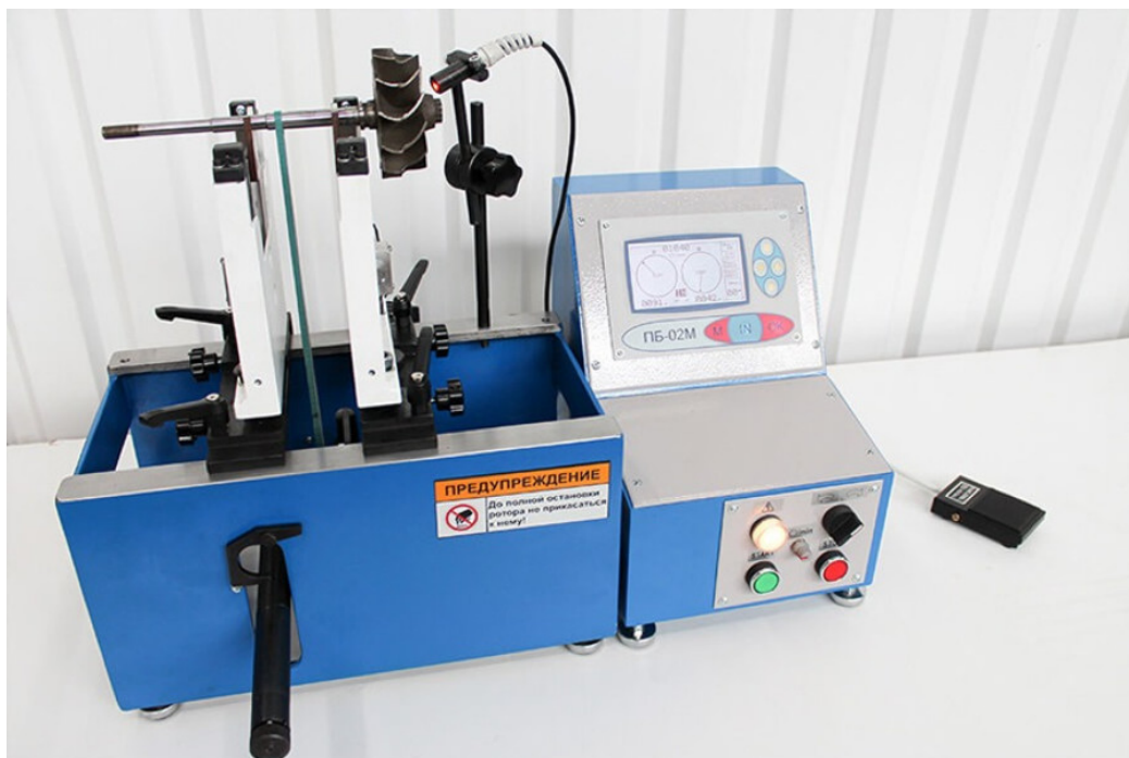
Slika 6.7. Stroj za balansiranje vratila i rotora turbine te kompresora
