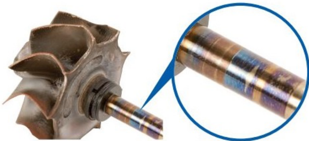
Slika 5.1. Modra boja na vratilu turbopuhala
