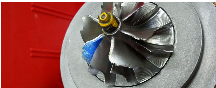
Slika 6.5. Puknuće lopatica rotora turbopuhala
