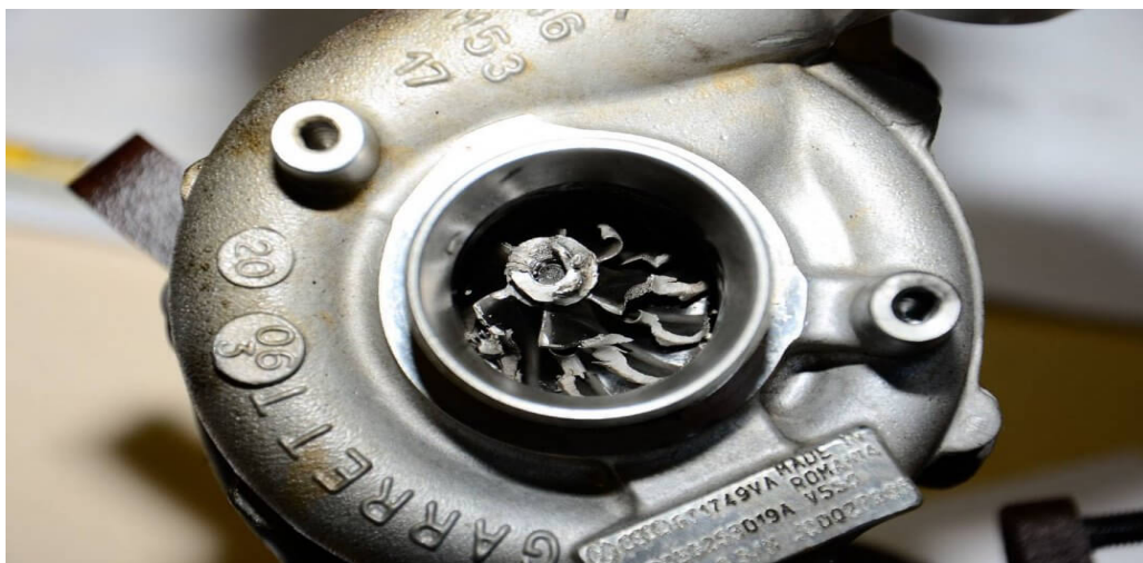
Slika 5.3. Oštećenje lopatica turbopuhala
