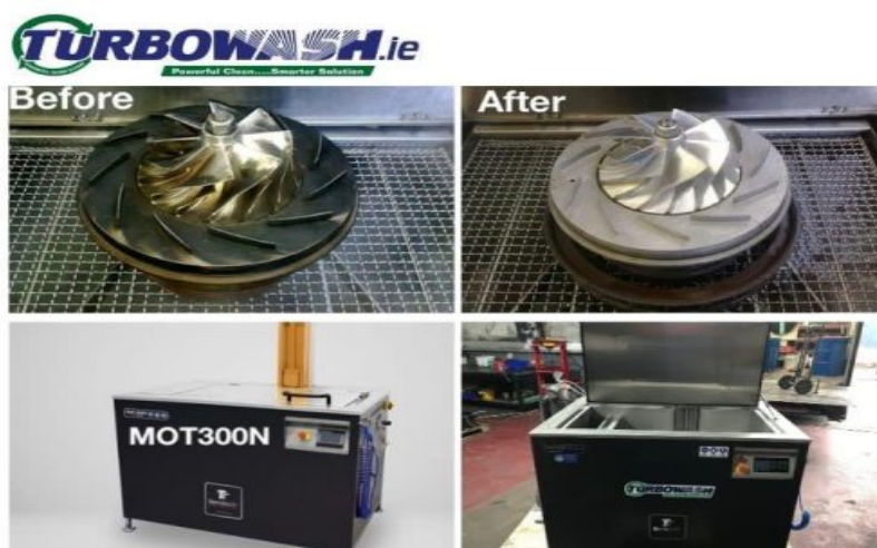
Slika 7.4. Ultrazvučno čišćenje dijelova turbopuhala.
