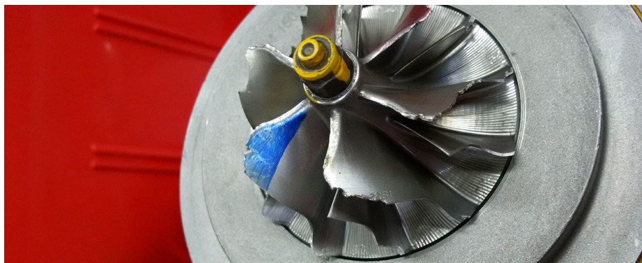
Slika 6.5. Puknuće lopatica rotora turbopuhala
