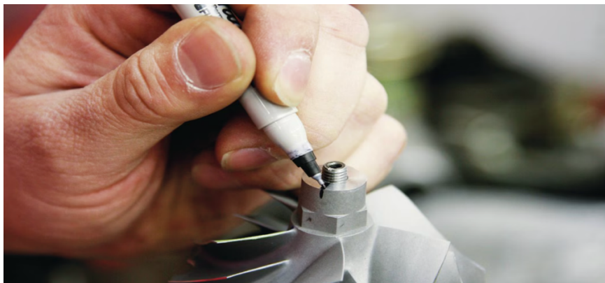
Slika 6.2. Označavanje položaja dijelova turbopuhala
