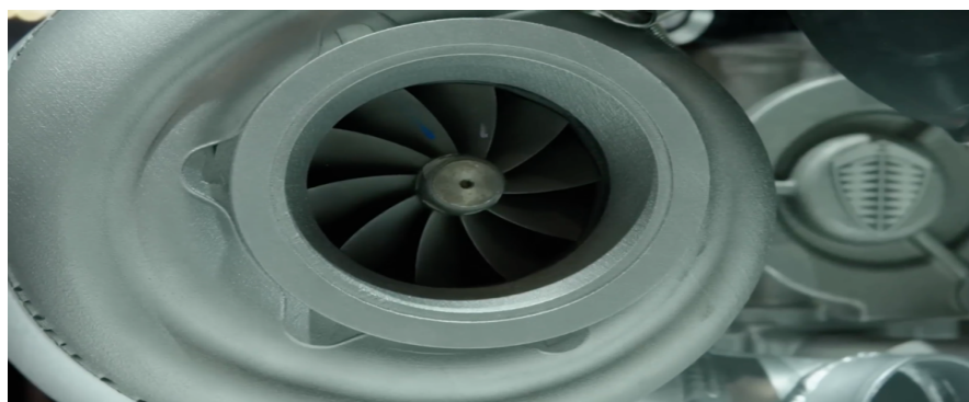
Slika 7.5. 3D printano kućište turbopuhala
