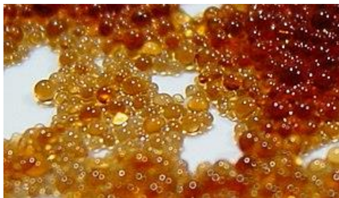
Slika 2.10. Ionski izmjenjivač ili „ionska smola“ [17]
