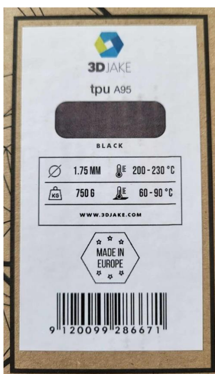
Slika 4.15. Preporučeni parametri za ispis s TPU materijalom
