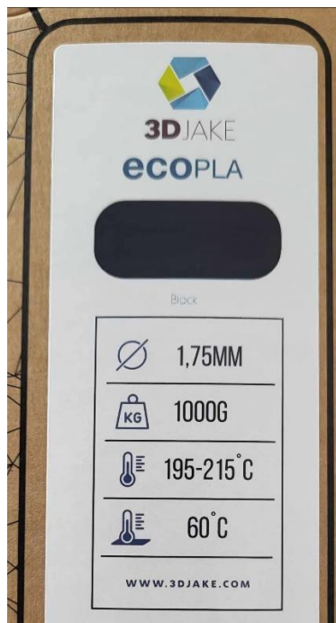
Slika 4.14. Preporučeni parametri za ispis s PLA materijalom
