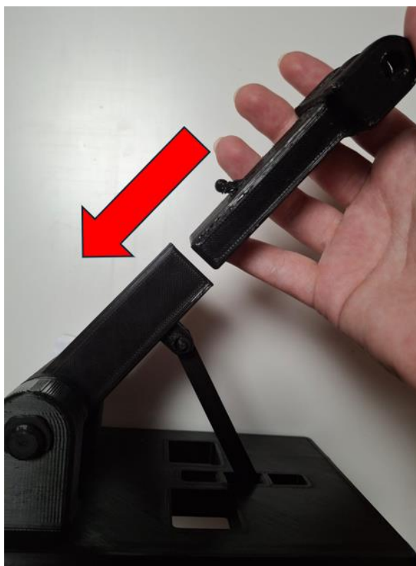
Slika 4.21. Montiranje vanjskog segmenta za reguliranje visine
