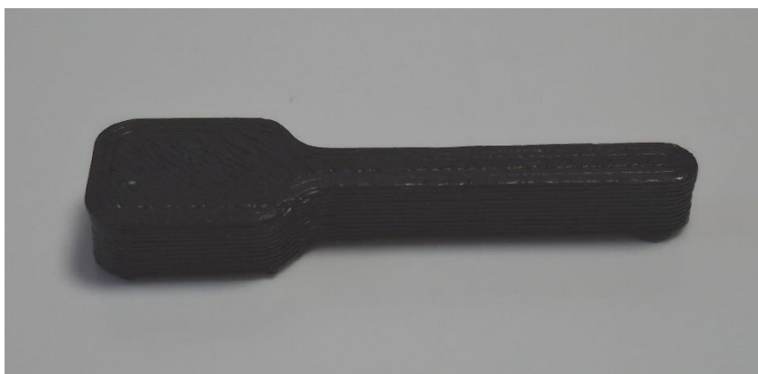
Slika 4.22. Dodatan segment za pritiskanje podatljivog elementa
