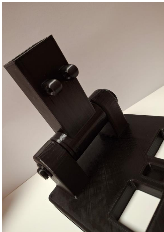
Slika 4.19. Vanjski segment za reguliranje visine montiran na bazu stalka
