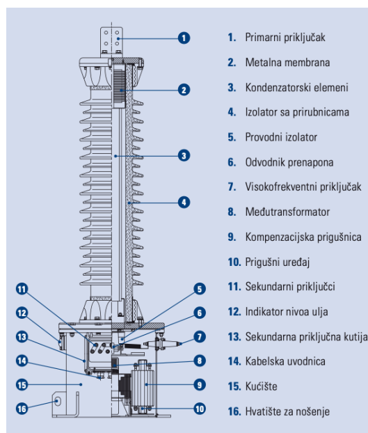
Slika 14: Presjek kapacitivnog naponskog mjernog transformatora [15]
