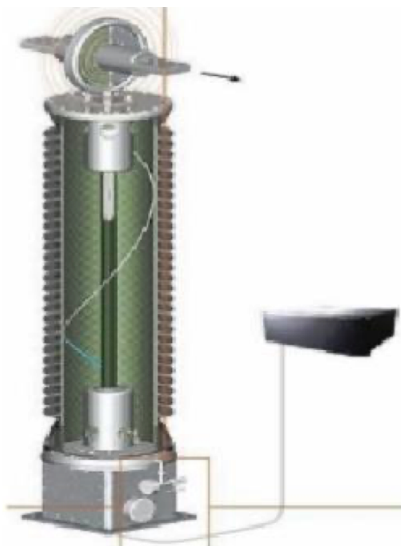
Slika 30: Nekonvencionalan strujni mjerni transformator sa optičkim senzorom
