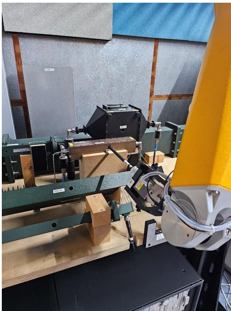
Slika 4.1.1 Kalibracija sonde u zraku
