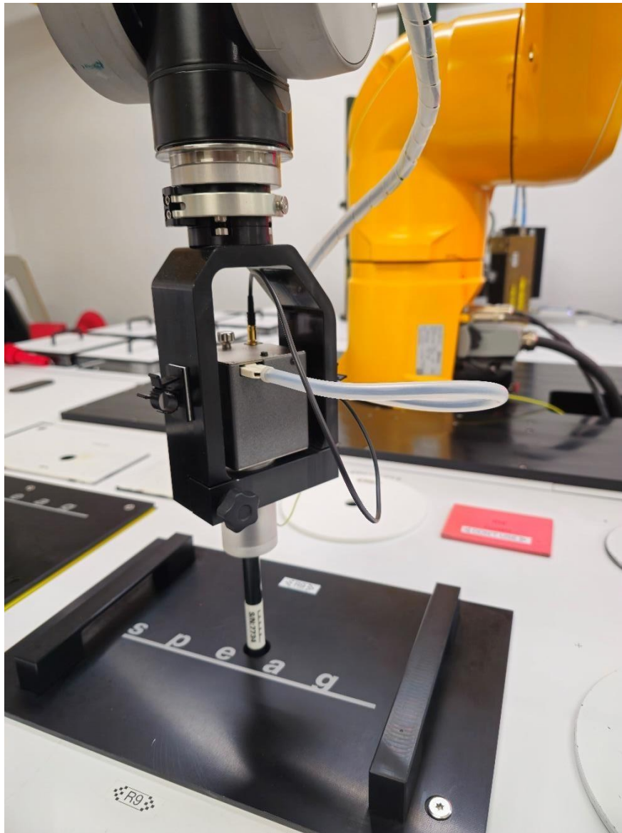
Slika 4.2.1 Mjerenje konverzijskog faktora
