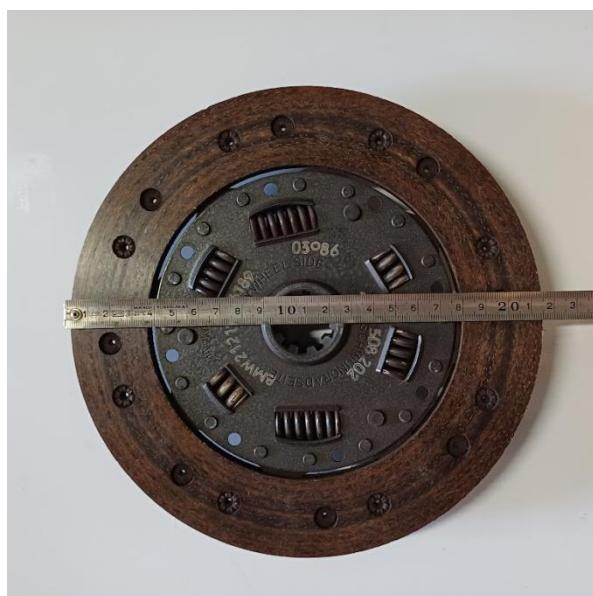
Slika 2.1 Mjerenje vanjskog promjera lamele
