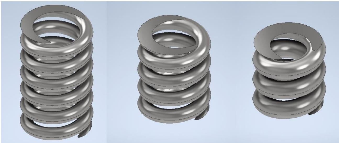
*Slika 3.8: Modeli cilindričnih zavojnih opruzi*
