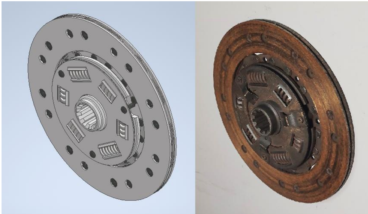
Slika 3.11: Usporedba prednje strane redizajnirane lamele sa postojećom
