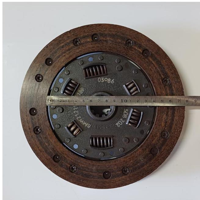
Slika 2.2 Mjerenje unutarnjeg promjera lamele
