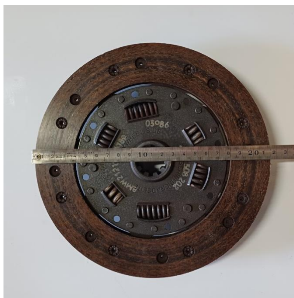
Slika 2.1 Mjerenje vanjskog promjera lamele
