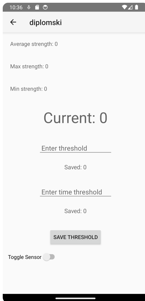
Slika 2.5 Zaslom za kalibraciju detekcije audio vibracija
