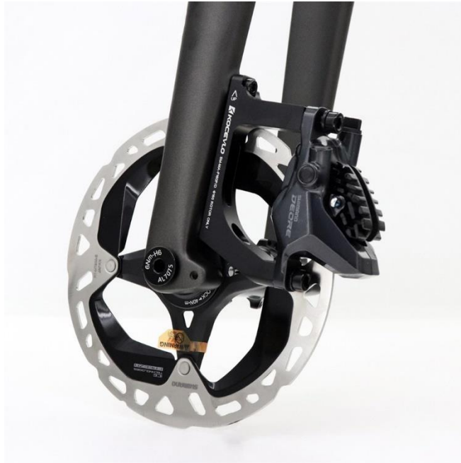
Slika 4.28. Montaža prednje disk hidrauličke kočnice dodatnim nosačem [21]
