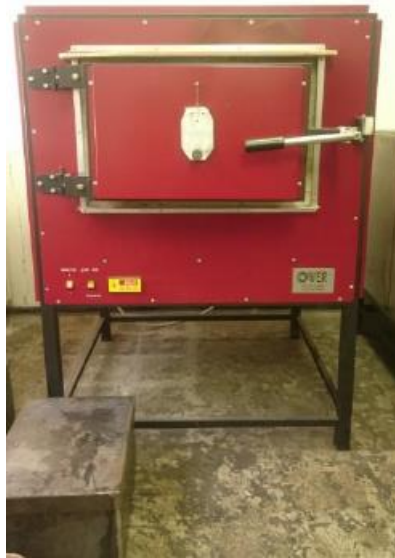
Slika 6.5. Komorna peć OVER snage 12 kW
