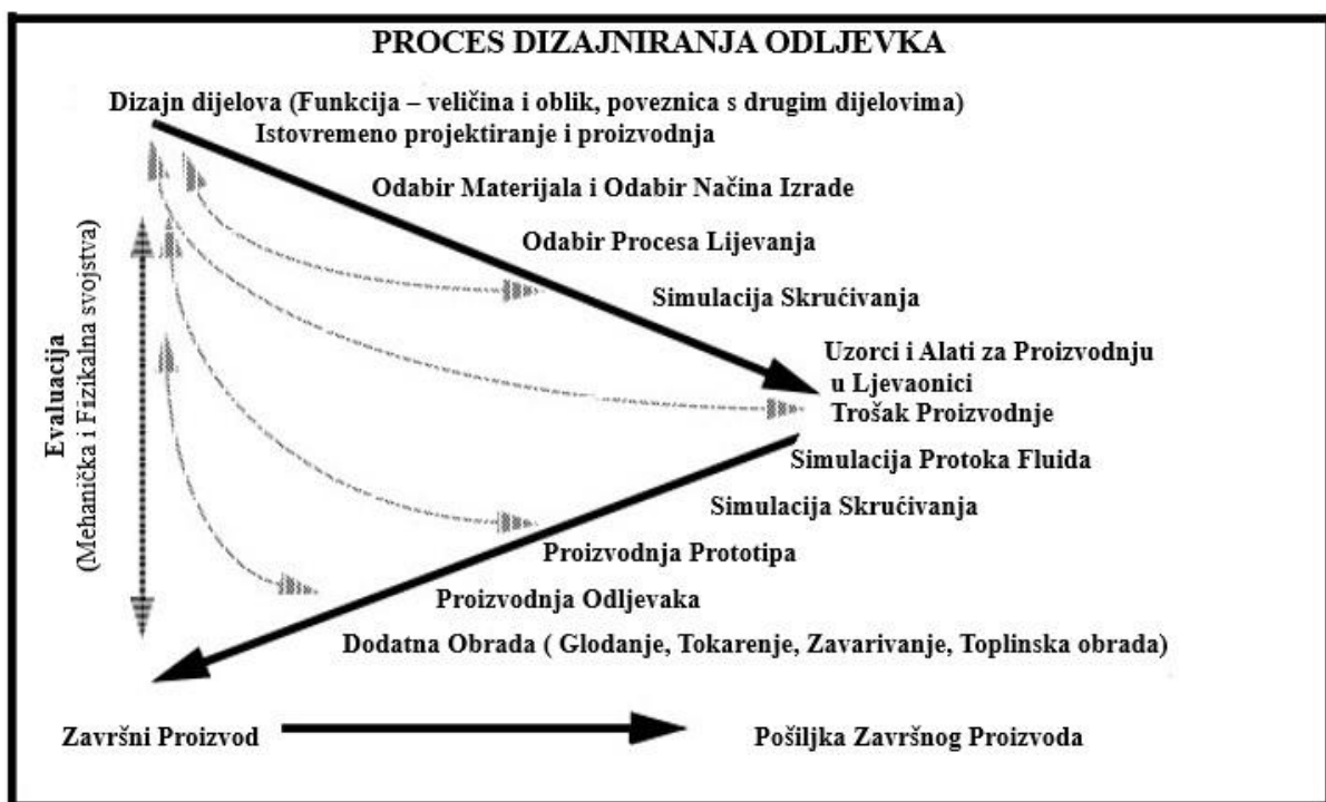
Slika 2.2. Proces dizajniranja odljevka [3]
