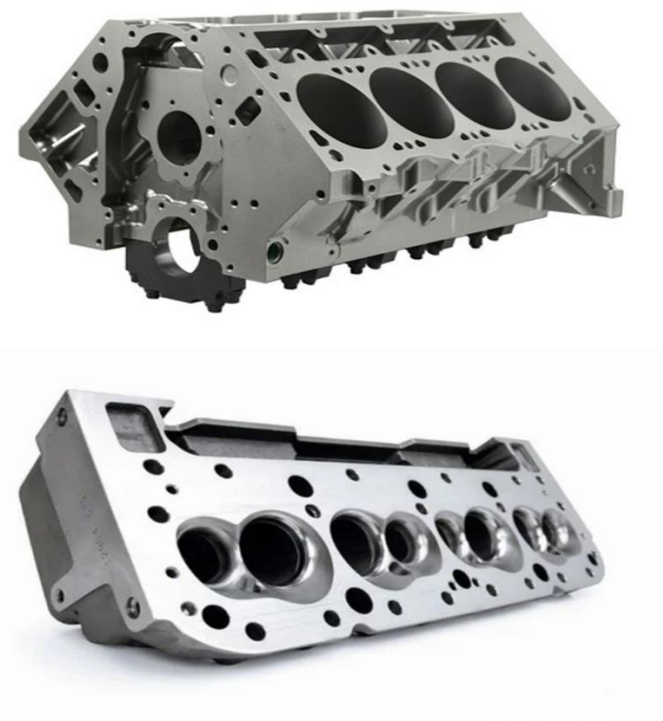
Slika 2.4. Odljevci bloka i glave motora od sivog lijeva [1]
