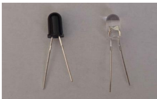
Slika 2.9. Foto-tranzistor (lijevo) i infracrvena dioda (desno).
