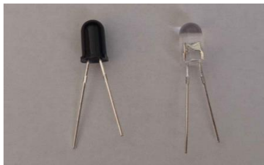
Slika 2.9. Foto-tranzistor (lijevo) i infracrvena dioda (desno).
