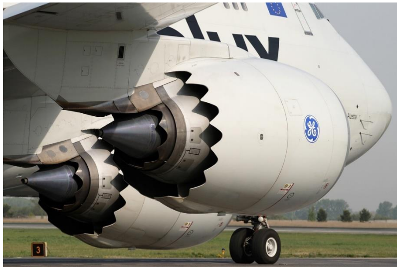
Slika 3.10. Nazubljena mlaznica i gondola GenX-2B motora [23]
