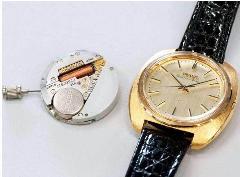
Slika 6- Prvi ručni kvarcni sat od Seika i njegov mehanizam [23]
