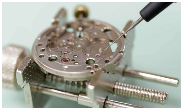
Slika 32- Stavljanje ulja na ležaj sata [47]
