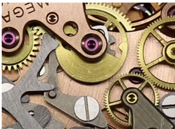
Slika 33- Zupčanici u kontaktu kod satnog mehanizma [48]
