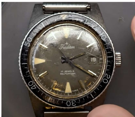
Slika 36- Oštećeno staklo i okvir sata.[50]
