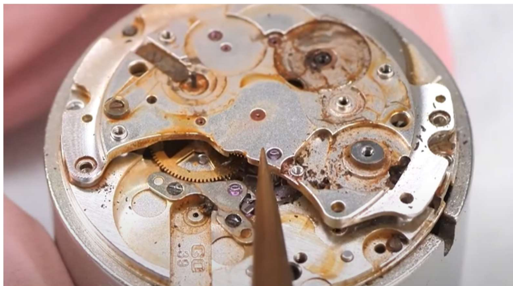
Slika 41- Prikaz korozije na satnom mehanizmu [50]
