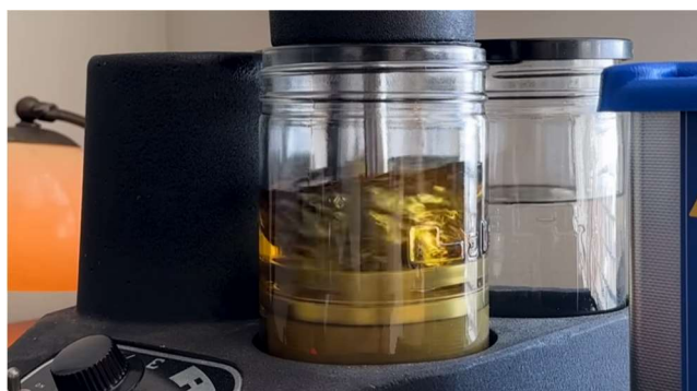
Slika 49- Centrifugalni čistač dijelova [50]
