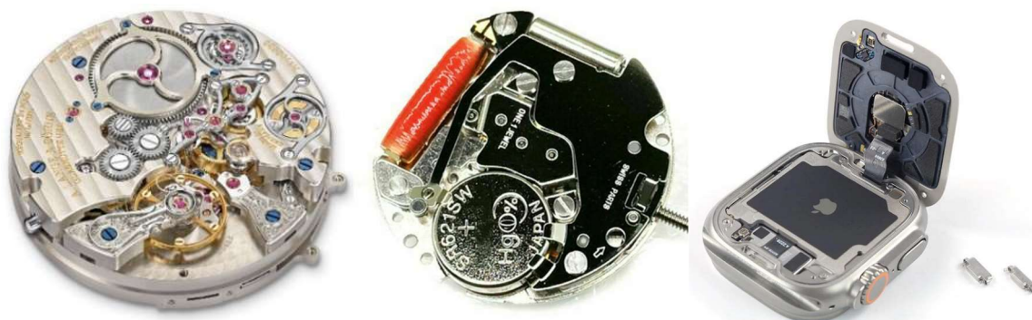
Slika 8- Usporedba mehaničkog, kvarcnog i mehanizma pametnog sata [25]
