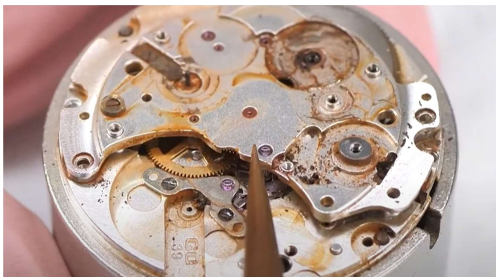
Slika 41- Prikaz korozije na satnom mehanizmu [50]
