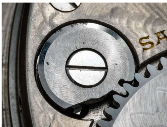
Slika 10- Zub za kočenje spiralne opruge [27]
