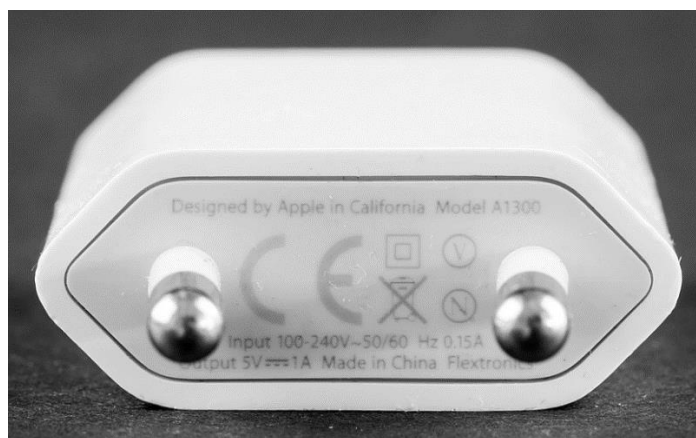
Slika 2.8 Primjer CE oznake na punjaču mobilnog uređaja
