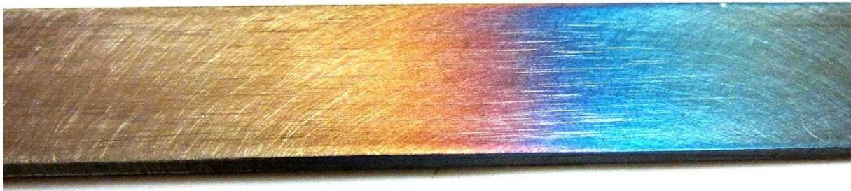
Slika 3.3. Kaljeni čelik nakon popuštanja [10]
