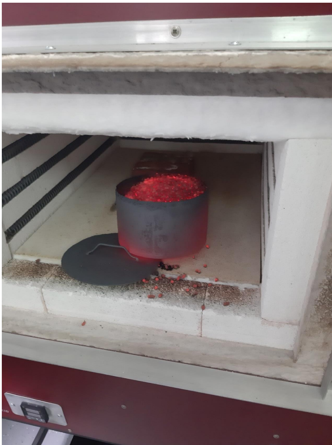
Slika 7.6. Posuda sa obratkom nakon pougljičavanja
