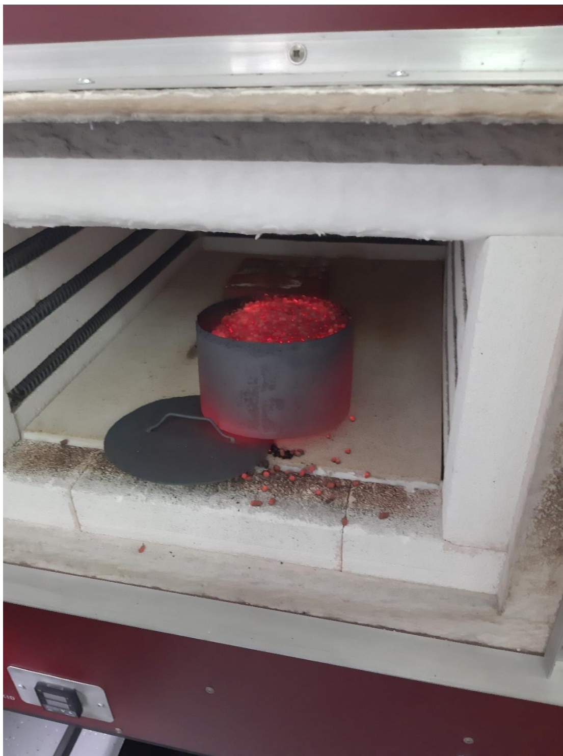
Slika 7.6. Posuda sa obratkom nakon pougljičavanja
