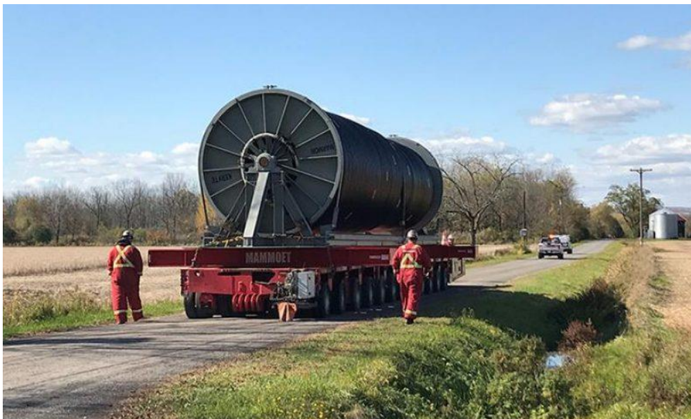
Slika 3.5. Cestovni transport pomorskog kabela [9]
