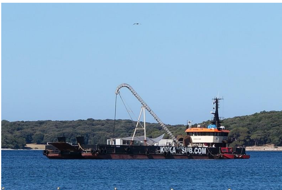
Slika 3.2. Brod za polaganje kabela na relaciji Premantura - Pomer [6]
