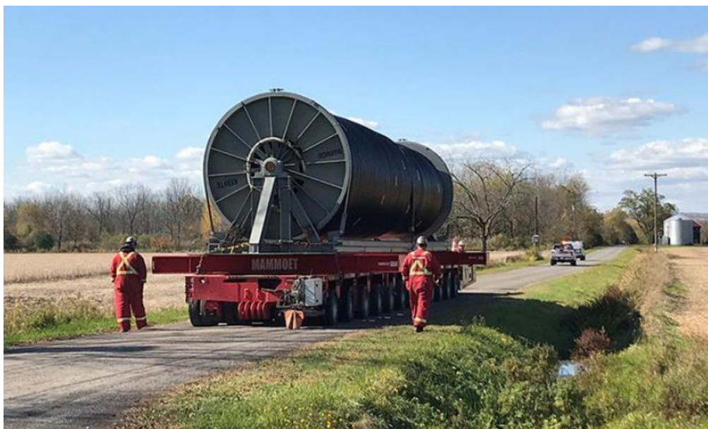
Slika 3.5. Cestovni transport pomorskog kabela [9]
