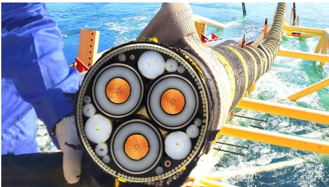
Slika 2.1 Presjek podmorskog kabela [2]
