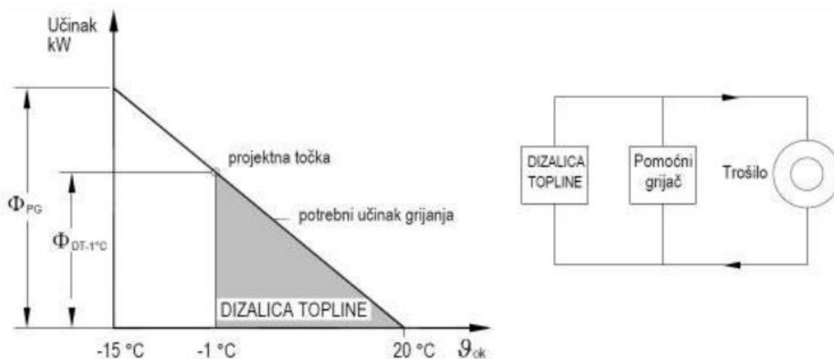
Slika 114. Način rada dizalice topline [7]
