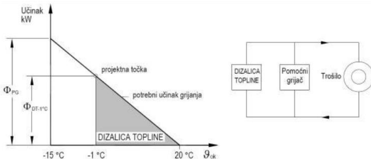
Slika 114. Način rada dizalice topline [7]
