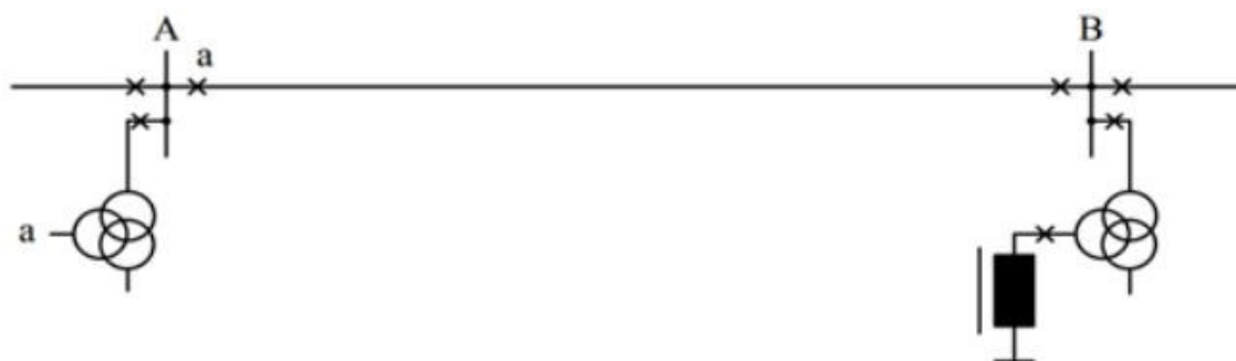
Slika 5.4. Shema spoja prigušnice na tercijar transformatora [5]
