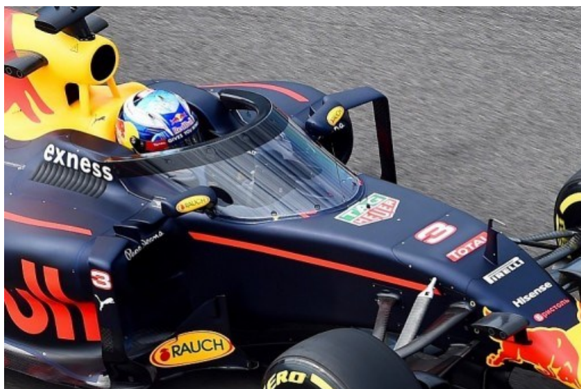
Slika 2.5 Testiranje Aeroscreen koncepta od strane Red Bull Advanced Technologies [10]
