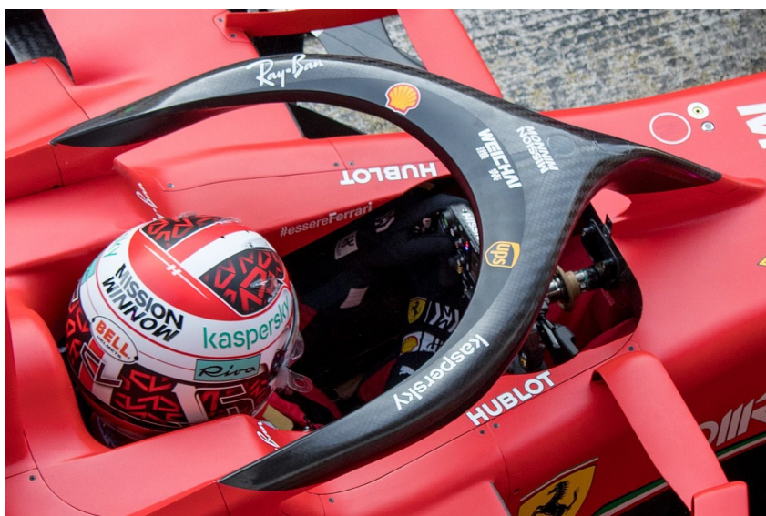
Slika 3.1 AFP-Halo na vozilu Formule 1 [12]
