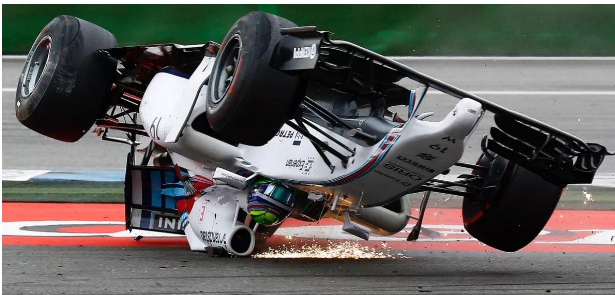
Slika 2.4 Zaštitna konstrukcija iznad glave vozača sprječava da vozilo prignječi vozača [7]
