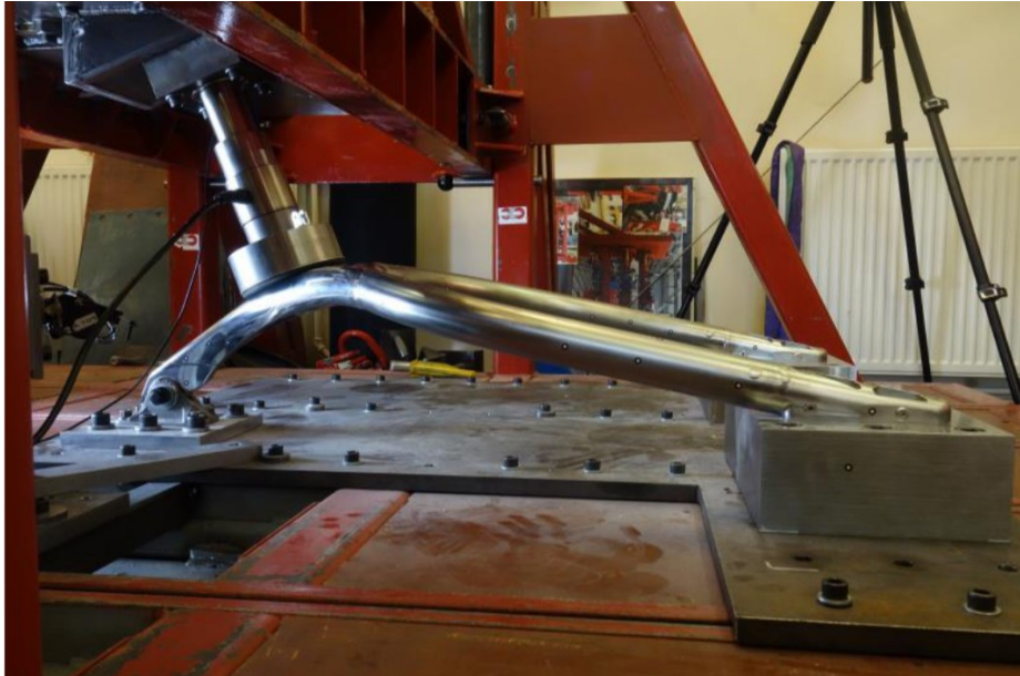
Slika 3.4 Provedba kvazistatičkog testa 1 [11]
