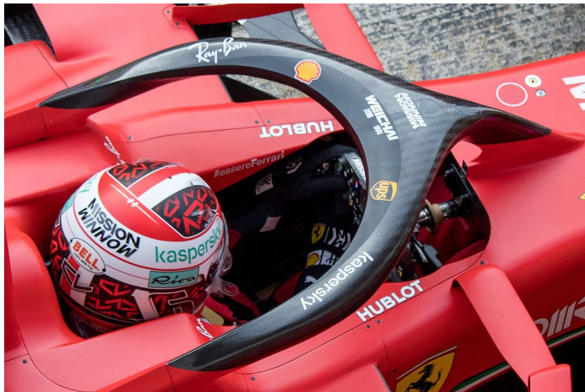
Slika 3.1 AFP-Halo na vozilu Formule 1 [12]
