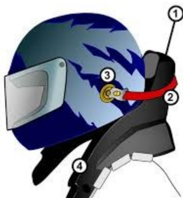
Slika 2.3 Skica HANS uređaja za zaštitu vrata vozača [6]
