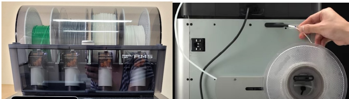
Slika 3.13 AMS (lijevo) i vanjski držač filamenta (desno) Bambu Lab X1 Carbon pisača [19]
