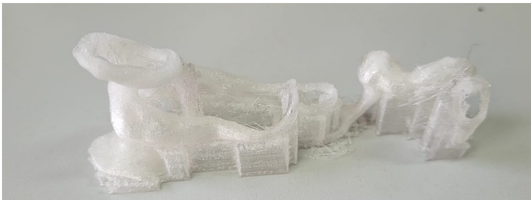
Slika 7.6 3D tiskano pomagalo s potpornim materijalom
