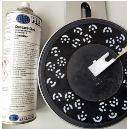
Slika 3.3 Sprej za oblaganje površina zahtjevnih za skeniranje uz primjer primjene
