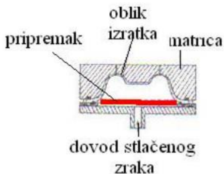
Slika 3.4 Postupak toplog oblikovanja stlačenim zrakom u matrici [7]
