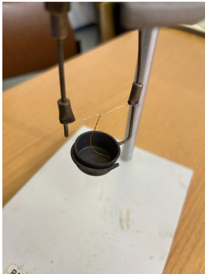
Slika 6 Posudica uzorka sa postavljenom nikromskom žicom i koncem
