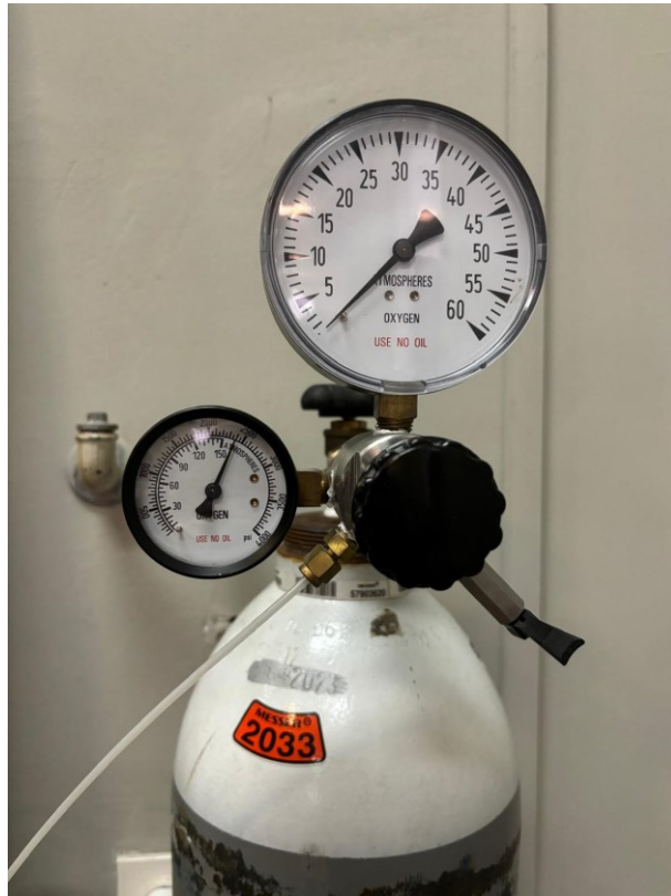
Slika 7 Manometar spremnika stlačenog kisika
