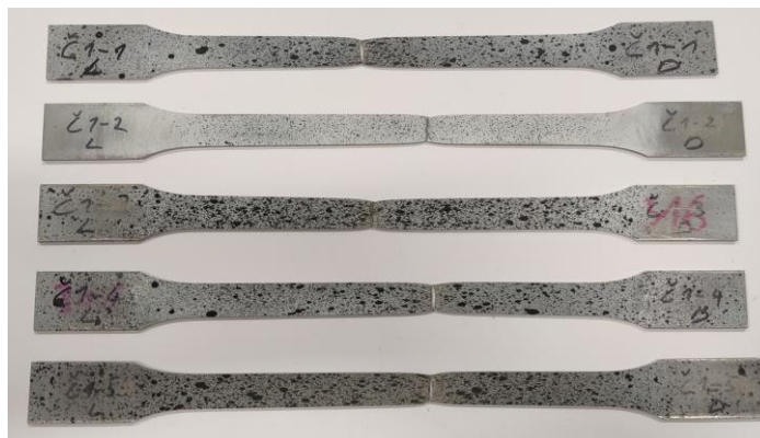
Slika 5.37. Komplet polomljenih ispitnih uzoraka korozivski postojanog čelika C1-AISI 316L
