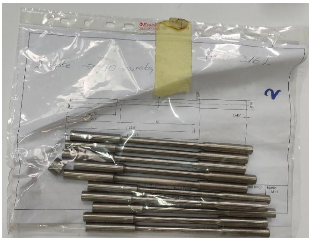
Slika 2.3. Set standardnih ispitnih uzoraka kružnog poprečnog presjeka
