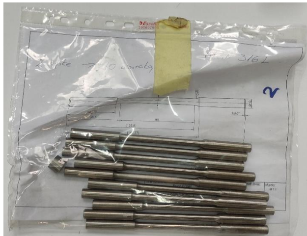
Slika 2.3. Set standardnih ispitnih uzoraka kružnog poprečnog presjeka
