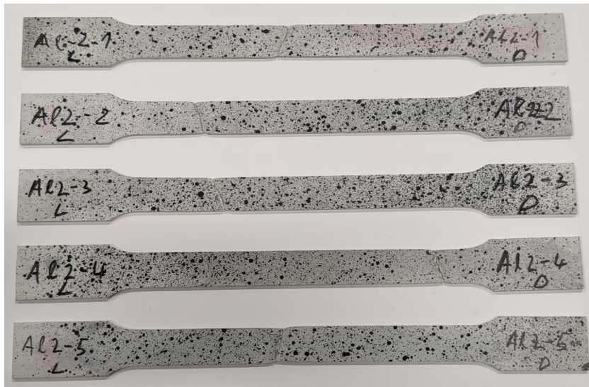
Slika 5.34. Komplet polomljenih ispitnih uzoraka legure aluminija Al2-AlMgSi0,5 debljine 3 mm
