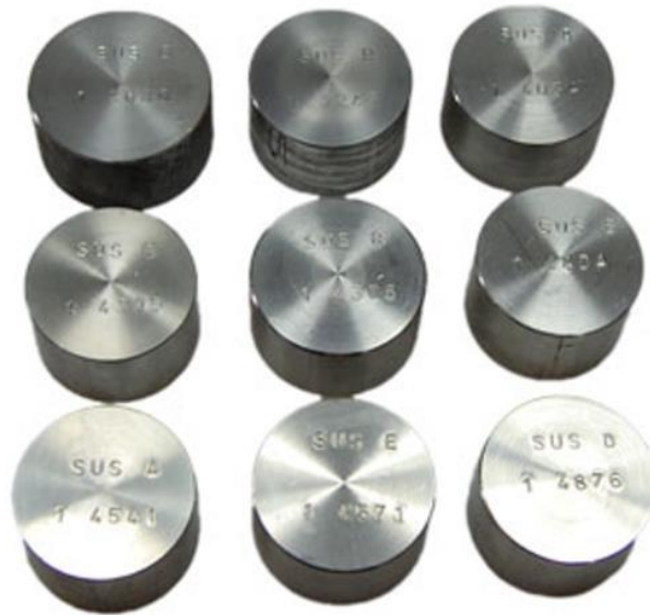
Slika 5.29. Set kalibracijskih uzoraka za ispitivanje visokolegiranih čelika [14]
