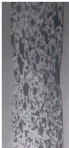
Slika 2.8. Smanjenje površine poprečnog presjeka (engl. Necking)-čelik AISI 304
