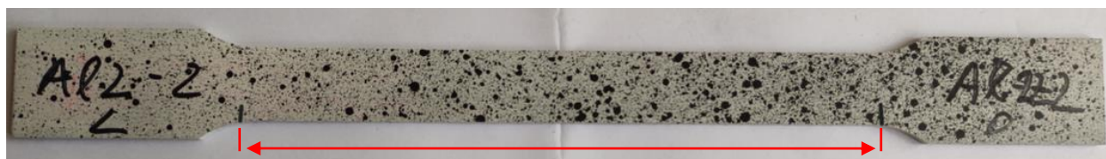
Slika 5.4. Primjer označene izvorne mjerne duljine
