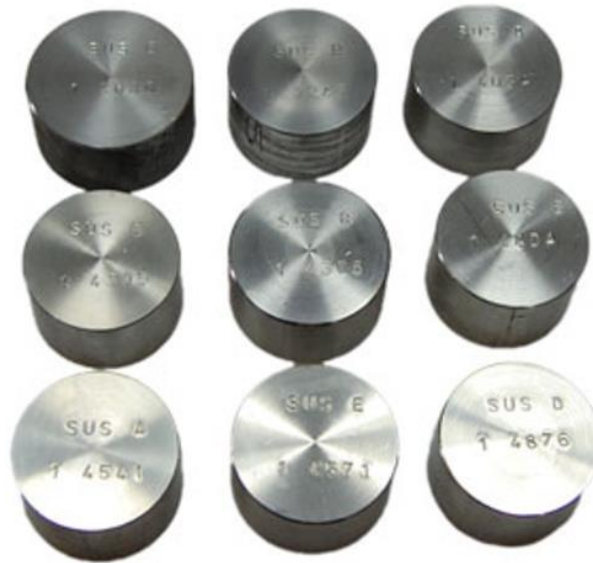
Slika 5.29. Set kalibracijskih uzoraka za ispitivanje visokolegiranih čelika [14]
