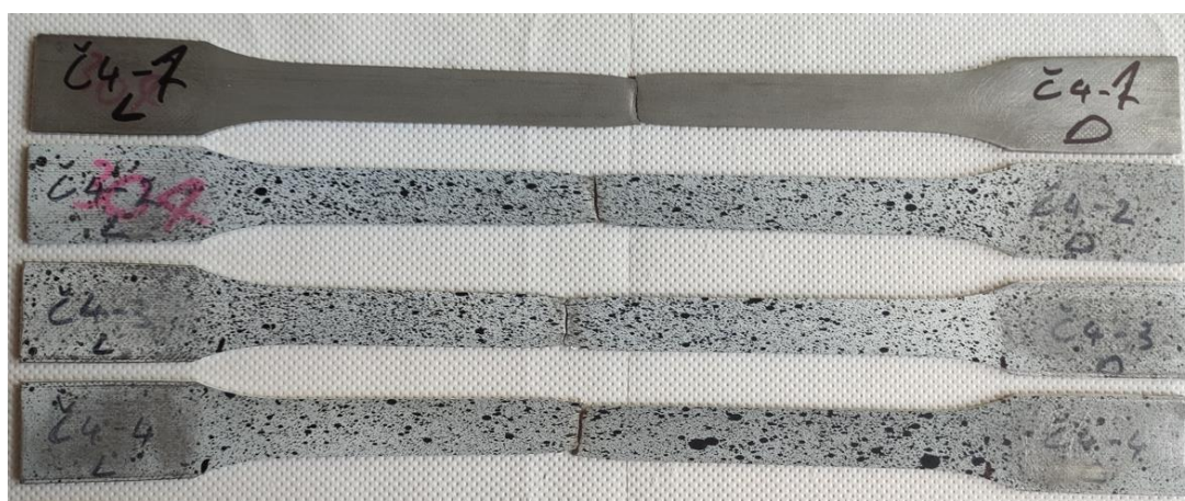
Slika 5.40. Komplet polomljenih ispitnih uzoraka korozijski postojanog čelika C4-AISI 304
