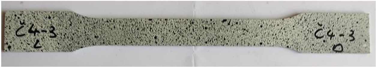
Slika 5.15. Ispitni uzorak s ispravnim rasterom
