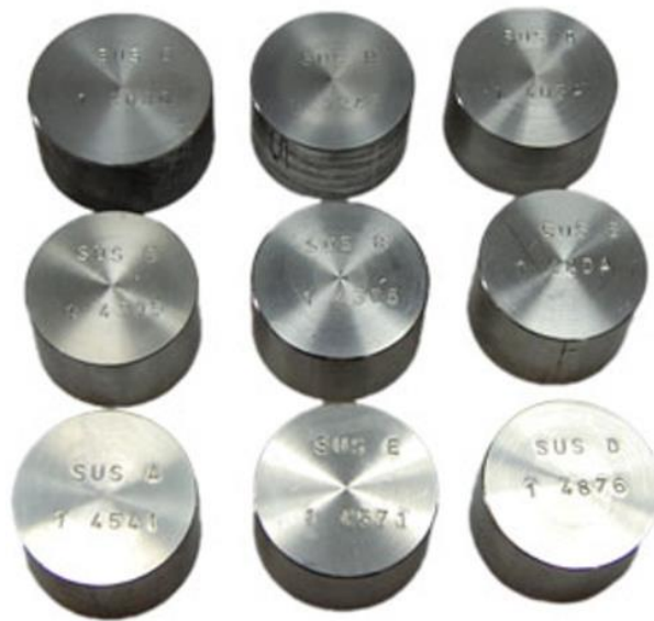
Slika 5.29. Set kalibracijskih uzoraka za ispitivanje visokolegiranih čelika [14]
