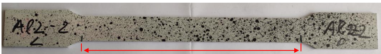
Slika 5.4. Primjer označene izvorne mjerne duljine
