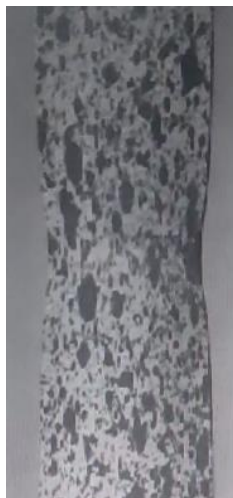
Slika 2.8. Smanjenje površine poprečnog presjeka (engl. Necking)-čelik AISI 304
