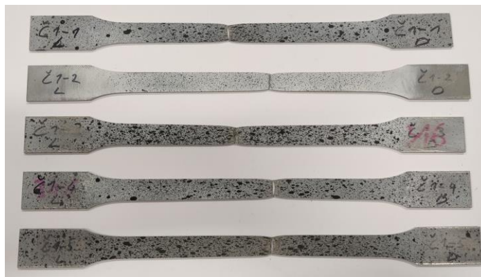
Slika 5.37. Komplet polomljenih ispitnih uzoraka korozijski postojanog čelika C1-AISI 316L
