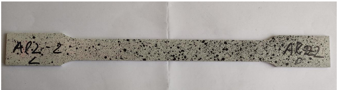
Slika 4.5. Uzorak na ispitnom tijelu
