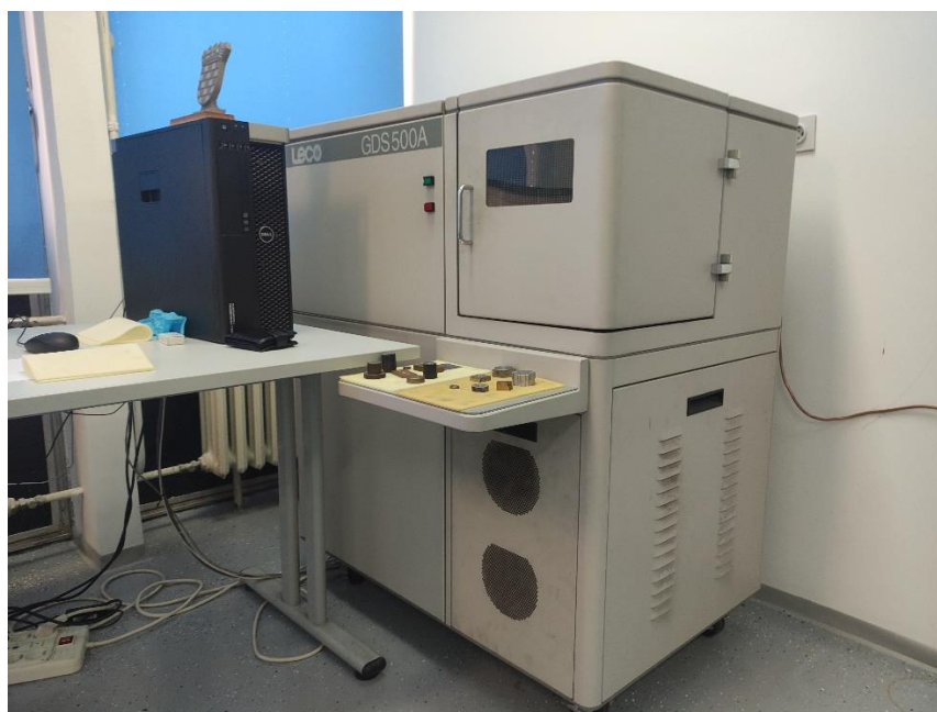
Slika 4.7. LECO GDS500A spektrometar
