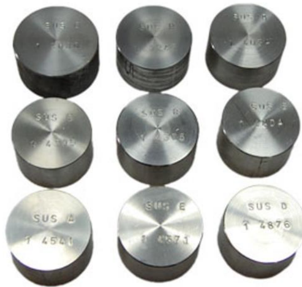
Slika 5.29. Set kalibracijskih uzoraka za ispitivanje visokolegiranih čelika [14]
