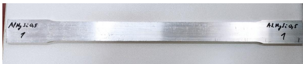
Slika 5.2. Ispitni uzorak AlMgSi0,5 debljine 5 mm
