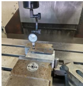
Slika 6.16. Centriranje izratka (operacija 20)
