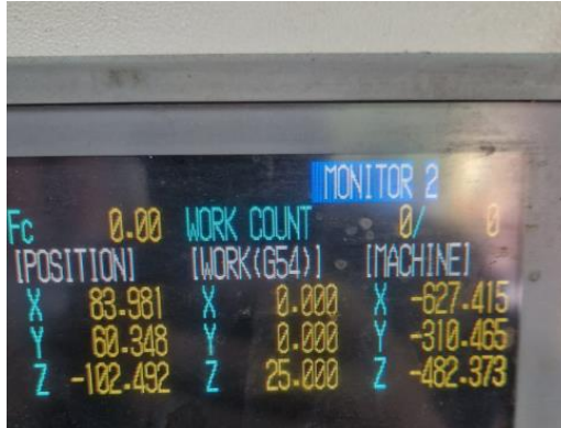
Slika 6.6. Pomicanje stroja u nultu točku
