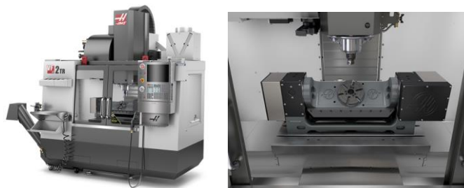
Slika 2.3. CNC stroj s 5 osi [2]
