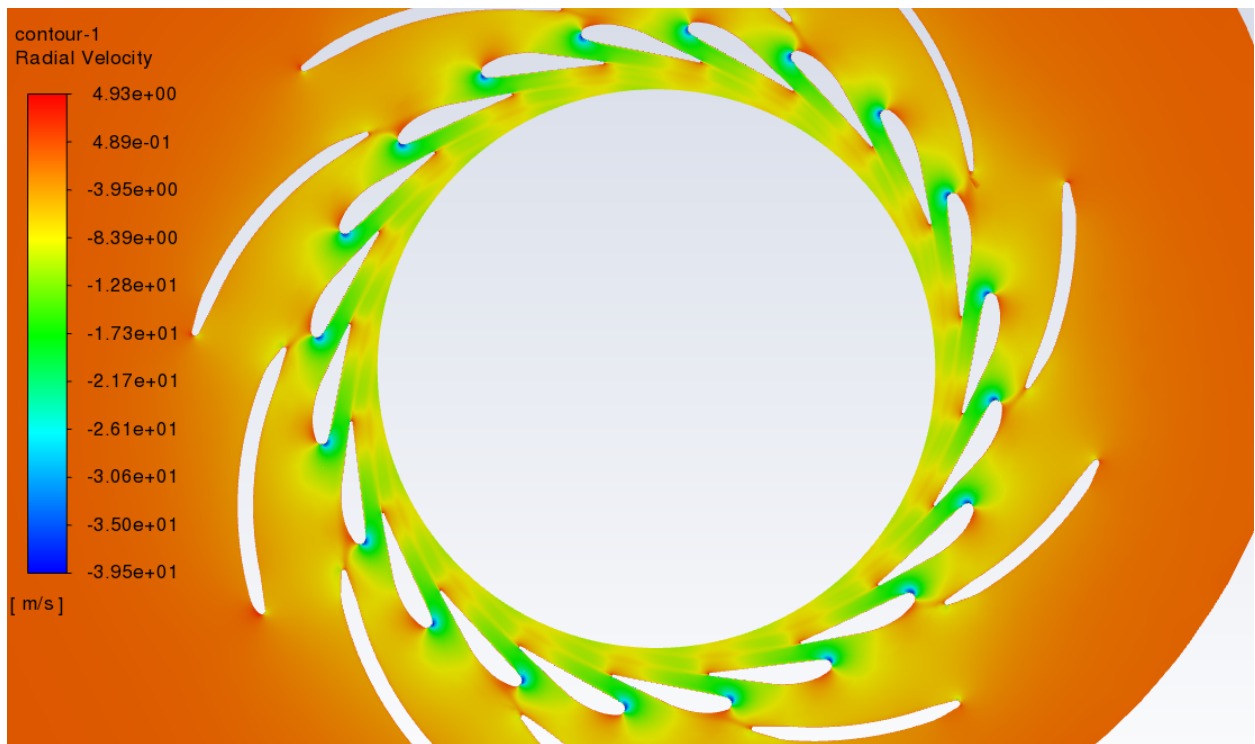
Slika 6-27 Konture radijalne brzine u iso ravnini
