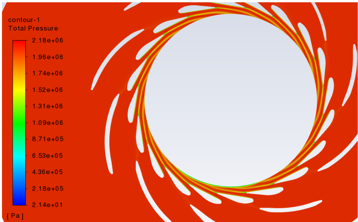
Slika 6-21 Konture totalnog tlaka u iso ravnini
