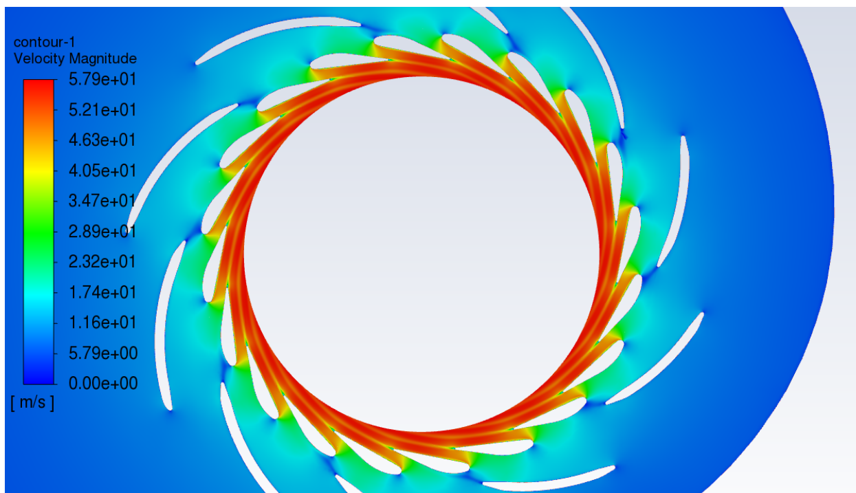
Slika 6-26 Konture magnitude brzine u iso ravnini
