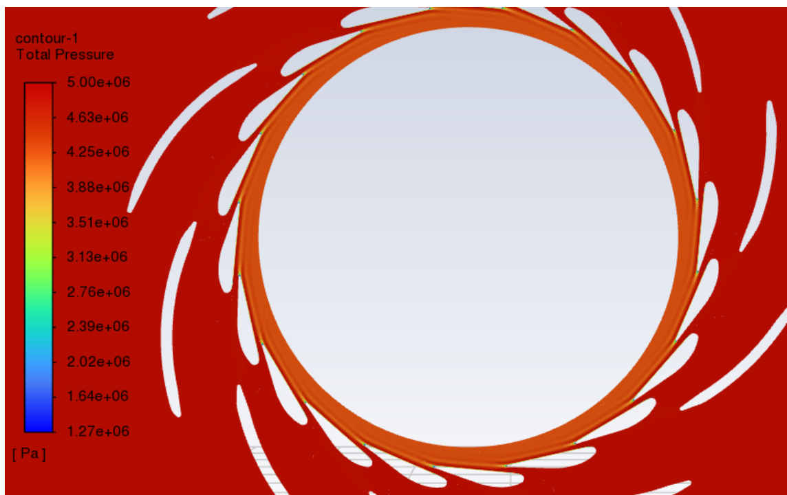
Slika 6-6 Konture totalnog tlaka u iso ravnini
