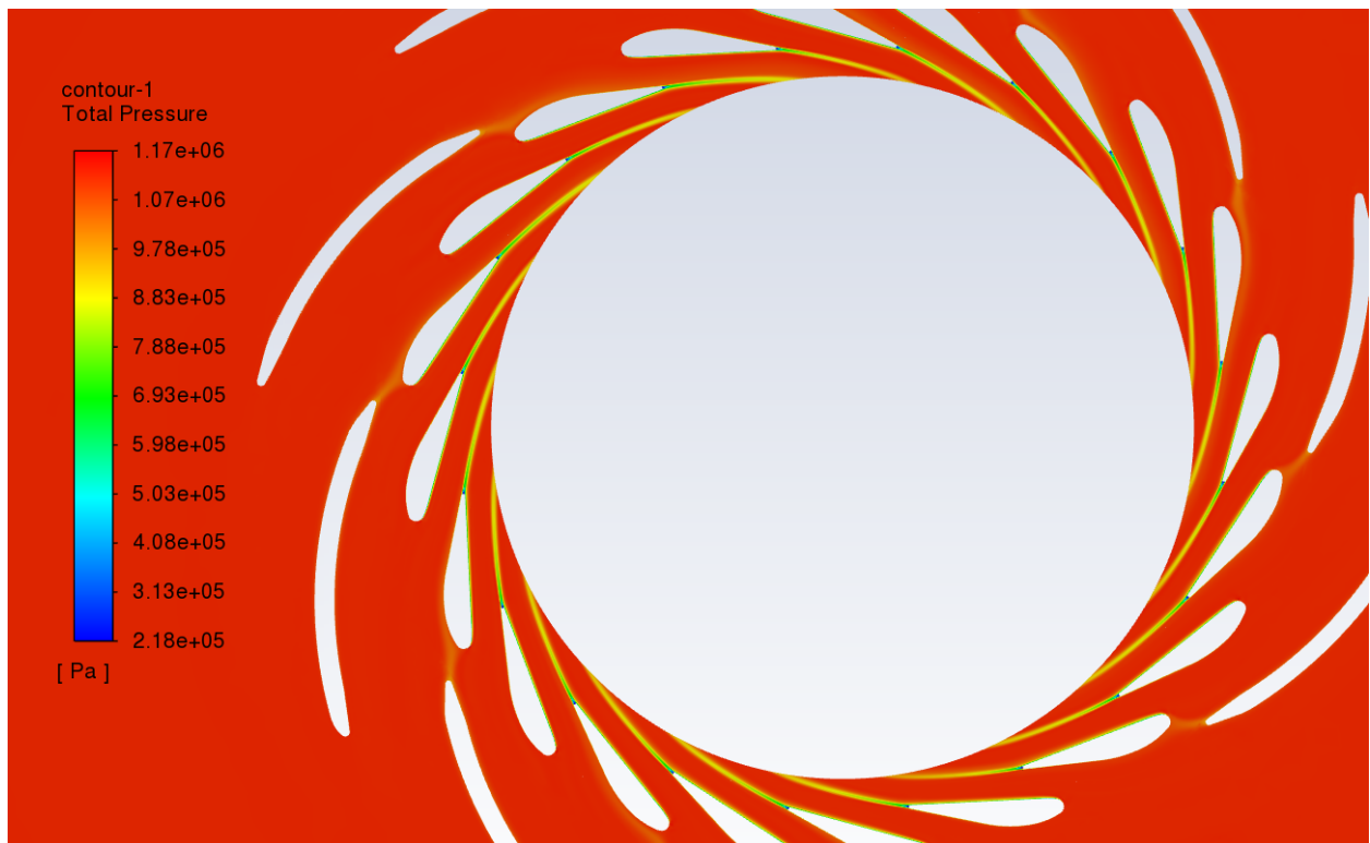
Slika 6-48 Konture totalnog tlaka u iso ravnini
