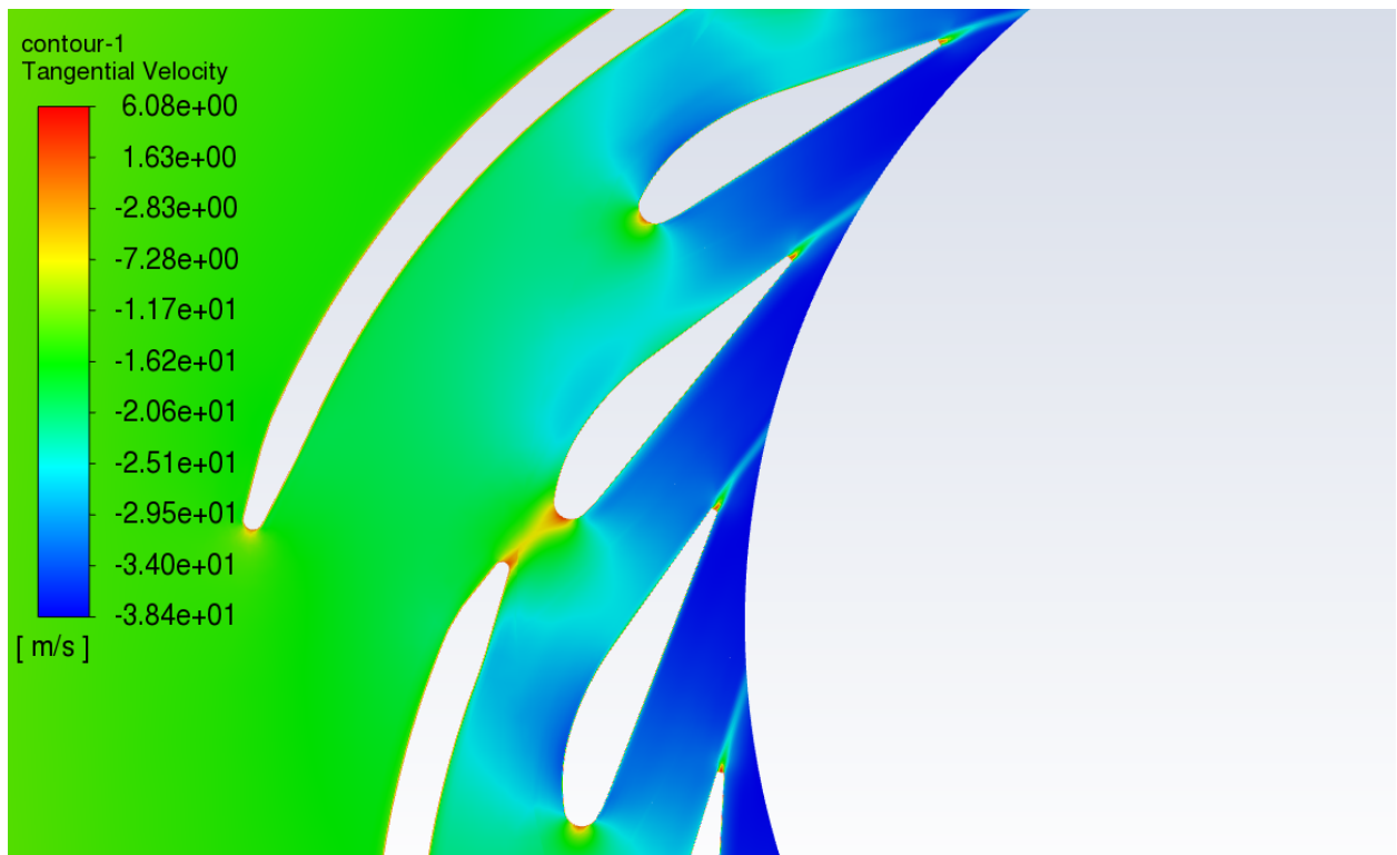
Slika 6-72 Konture tangencijalne brzine u iso ravnini
