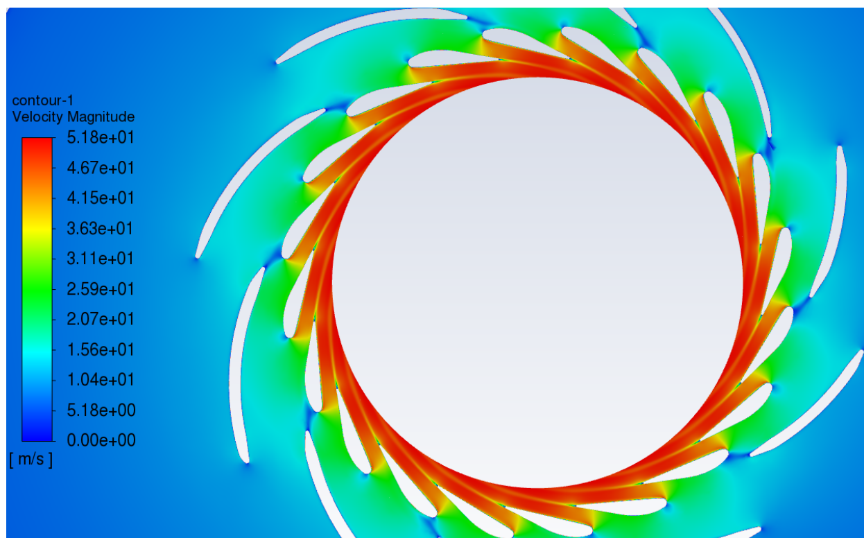
Slika 6-34 Konture magnitude brzine u iso ravnini
