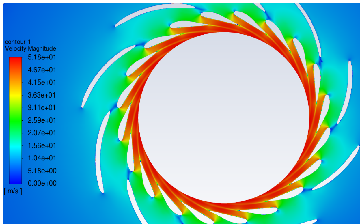
Slika 6-34 Konture magnitude brzine u iso ravnini
