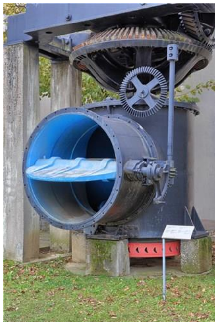
Slika 3.3 Vodna turbina Girard [3]
