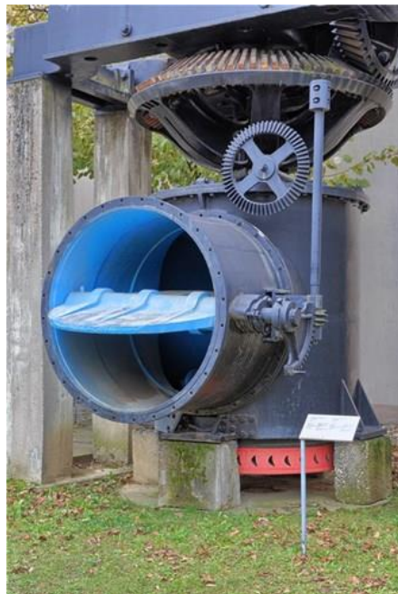
Slika 3.3 Vodna turbina Girard [3]
