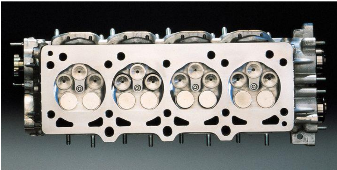
Slika 2.4. Konfiguracija s pet ventila po cilindru [6]
