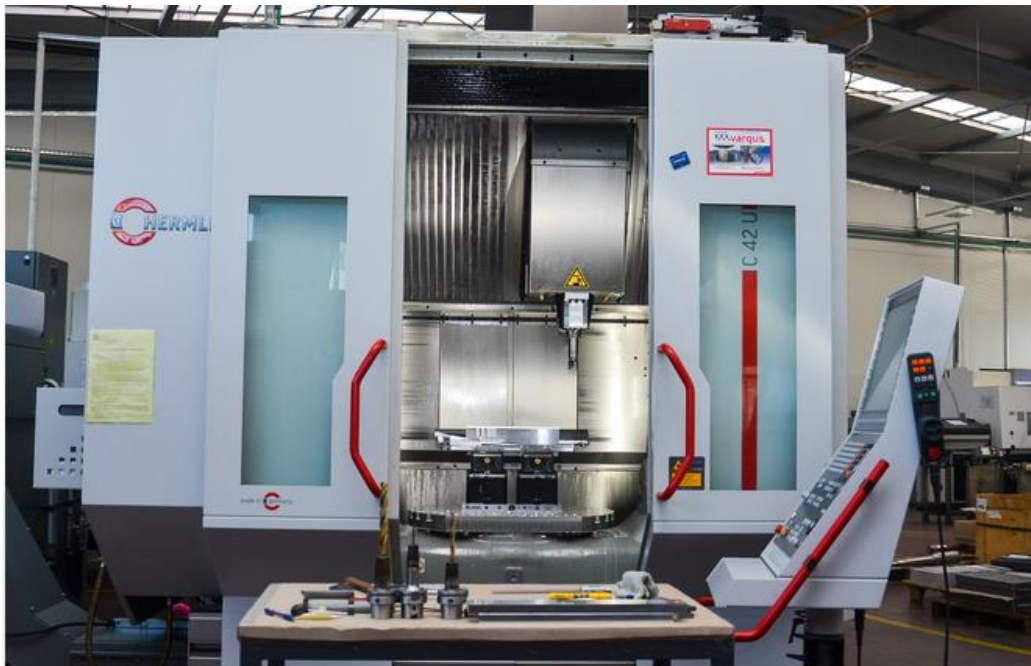
Slika 2.4.: CNC glodalica HERMLE C42.[7]
