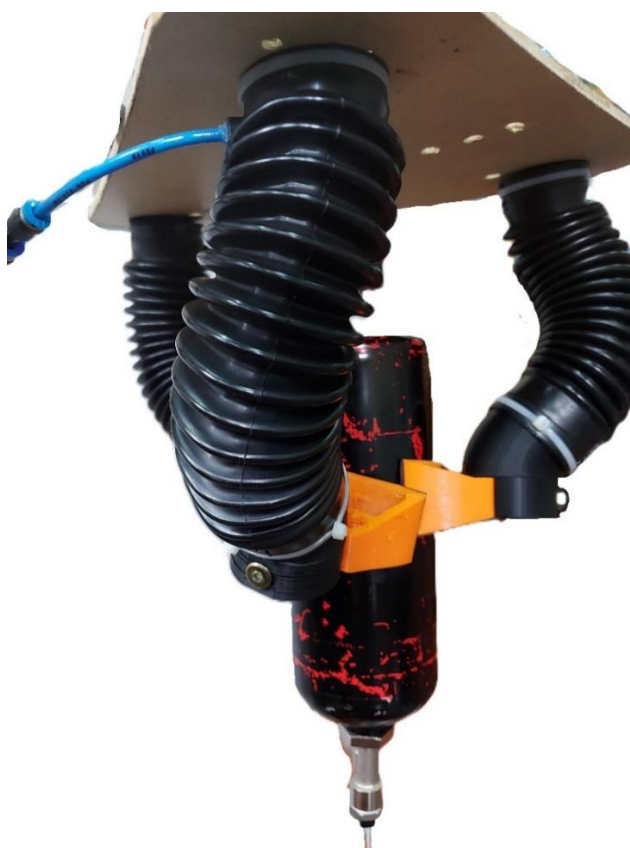
Slika 5.3.2. Deformacija hvataljke sa 3 aktuatora
