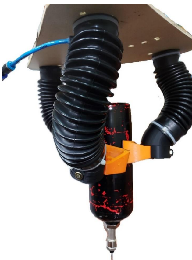
Slika 5.3.2. Deformacija hvataljke sa 3 aktuatora
