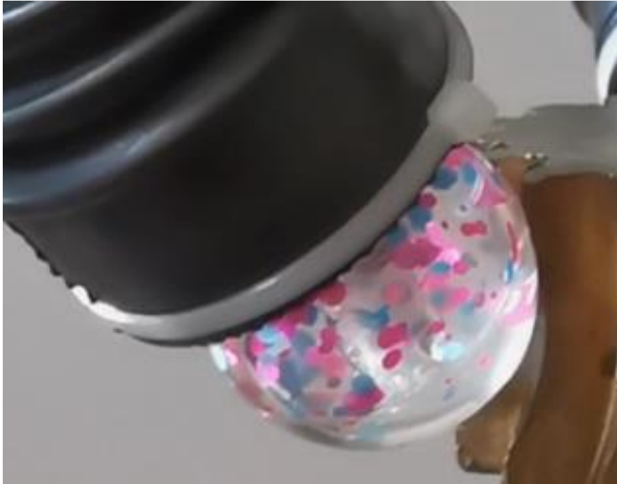
Slika 3.2.1. Točkasti prihvat kuglica i objekta hvatanja
