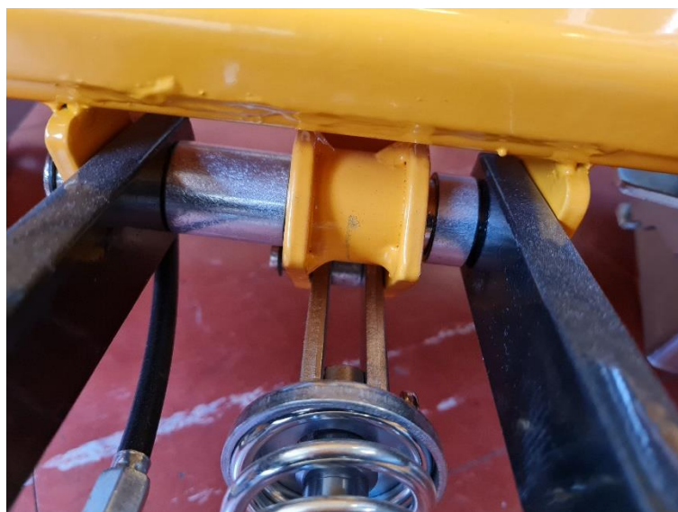
Slika 3.5. Spoj hidrauličkog cilindra i nosive konstrukcije
