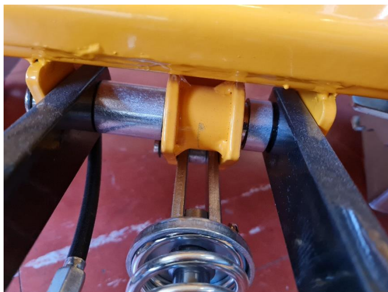
Slika 3.5. Spoj hidrauličkog cilindra i nosive konstrukcije
