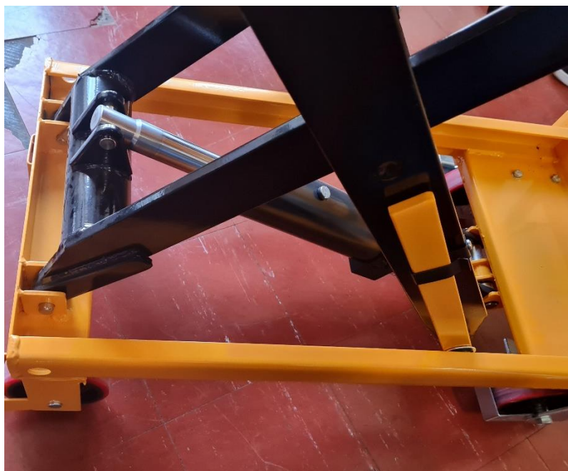
Slika 3.6. Spoj cilindra i unutarnjeg para poluga
