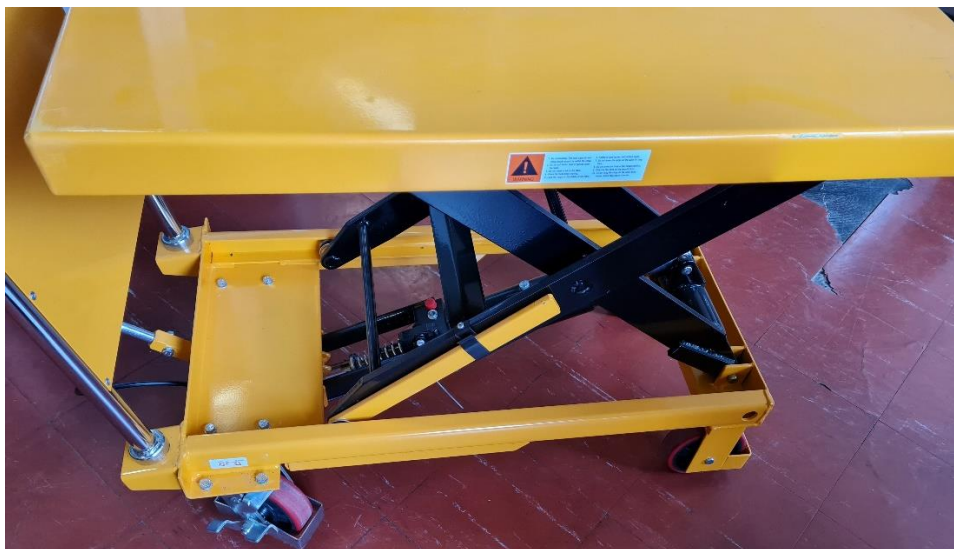
Slika 3.9. Spoj vanjskog para poluga s nosivom konstrukcijom
