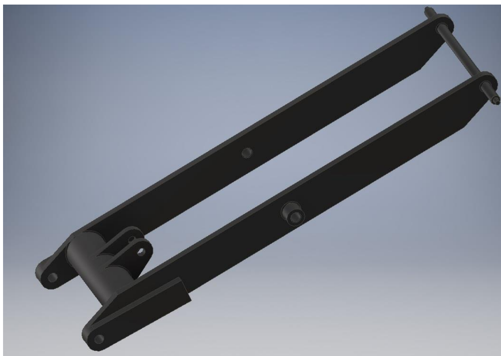
Slika 4.9. Unutarnji par poluga škarastog mehanizma
