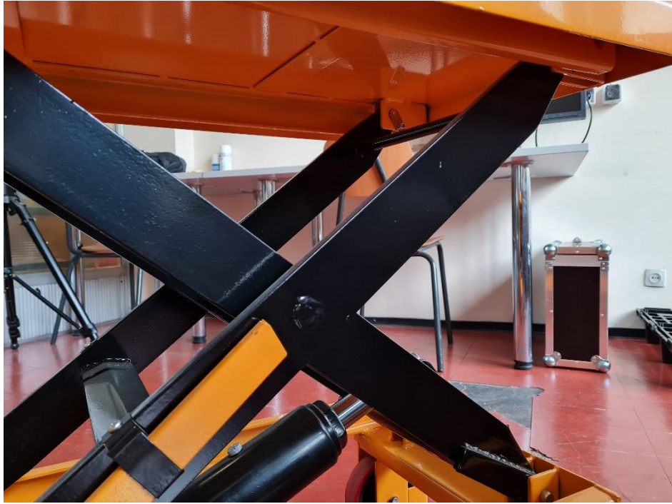
Slika 3.8. Spoj vanjskog para polugu i teretne platforme
