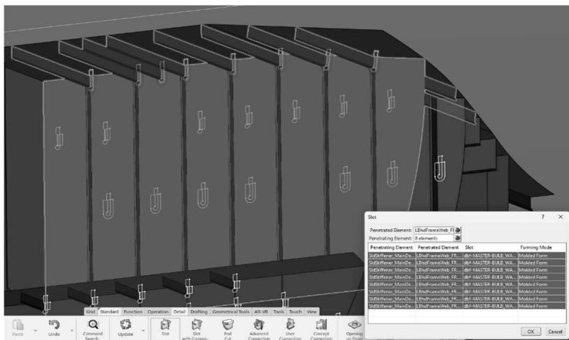
Slika 10.7. Prolaz za profile kroz vodonepropusnu pregradu
