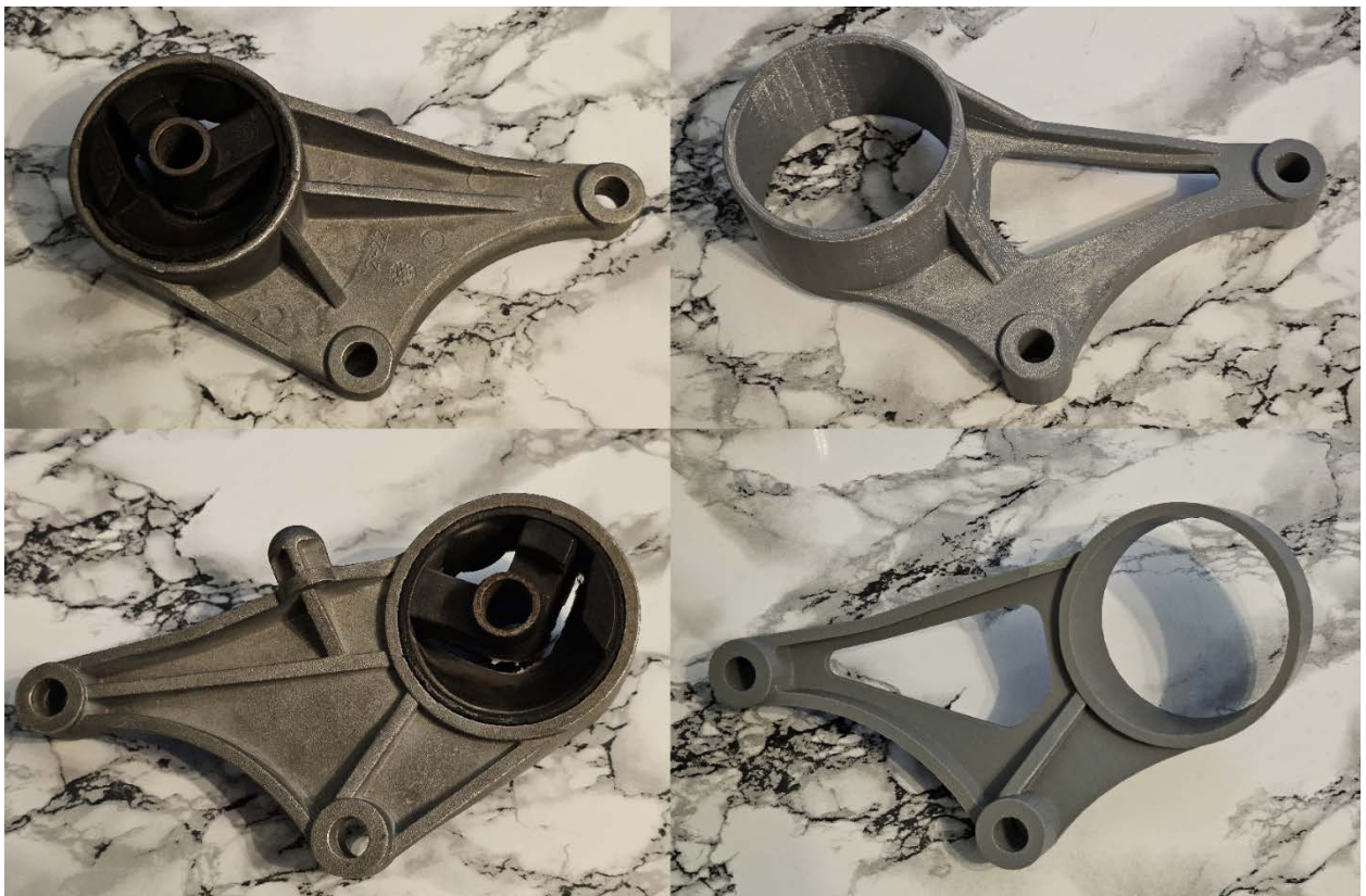
Slika 8.6 Usporedba stvarnog i optimiranog nosača
