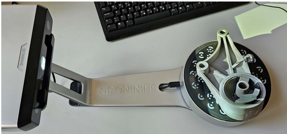
Slika 4.14 Skeniranje trećeg položaja nosača
