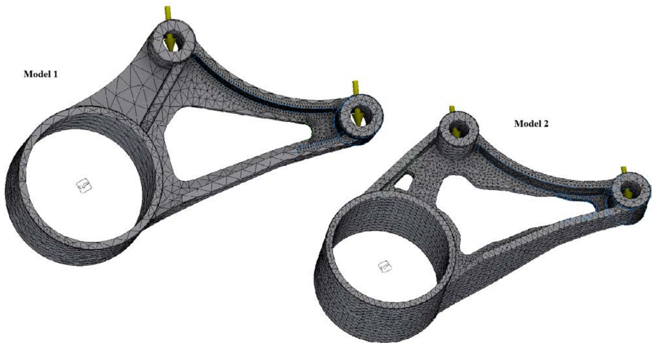
Slika 7.14 Lokalno izmijenjena mreža konačnih elemenata optimiranih modela
