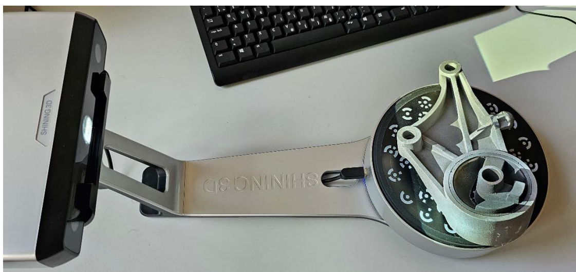
Slika 4.14 Skeniranje trećeg položaja nosača
