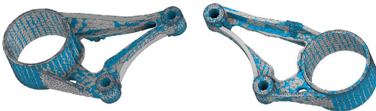
Slika 7.8 Usporedba preklapanja mreže i modela 2
