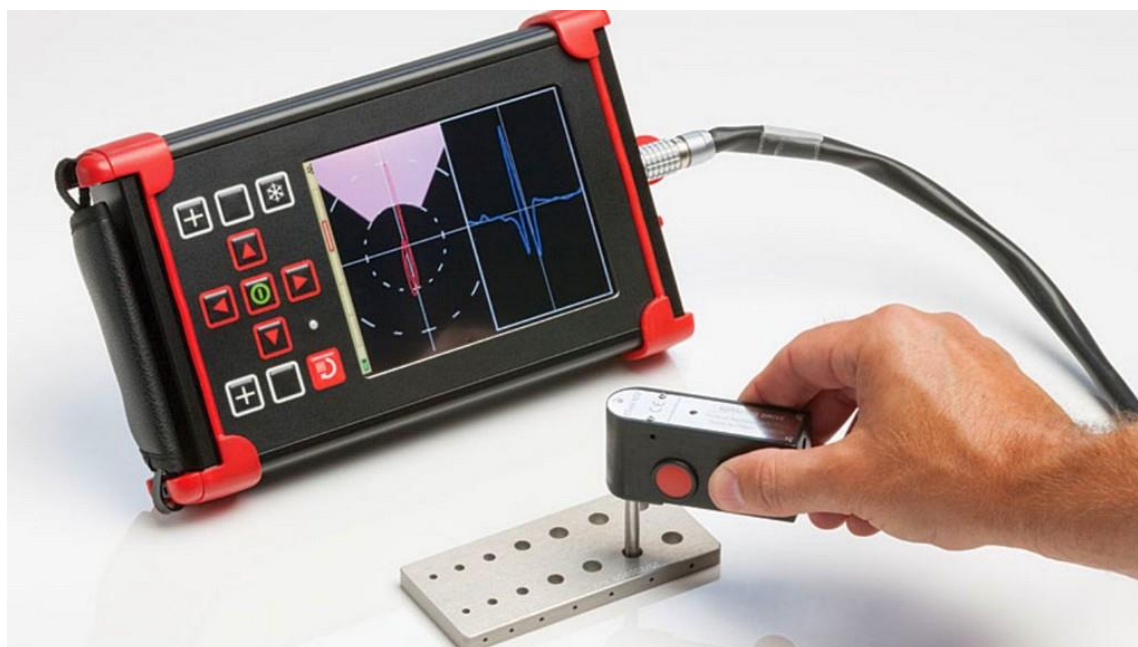
Slika 2.9. Uređaj za ispitivanje vrtložnim strujama [24]
