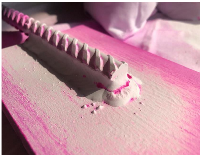
Slika 2.8. Ispitivanje zavara penetrantima [23]
