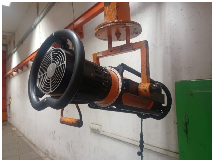
Slika 5.2 Rendgen uređaj korišten pri ispitivanju.
