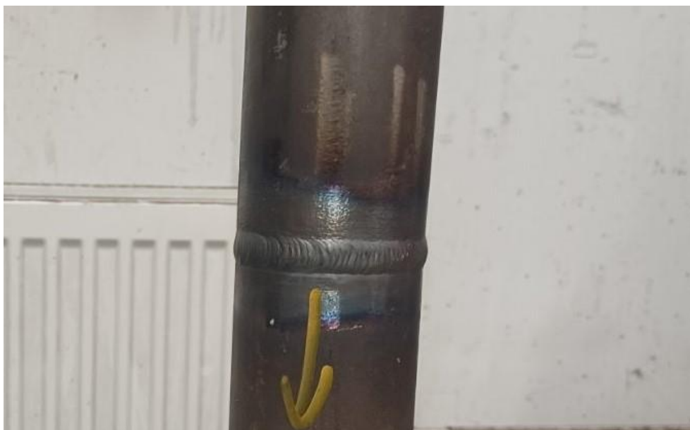
Slika 5.1. Prikaz zavarenog spoja strojnog dijela OT.24-SI.50
