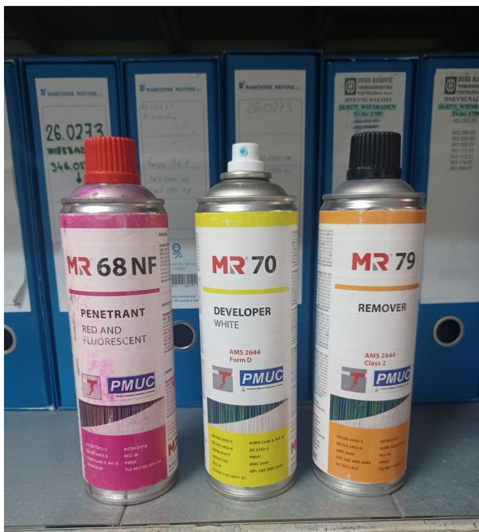
Slika 5.8. Penetrant, čistač i razvijач korišteni tijekom ispitivanja
